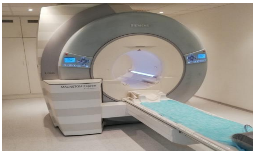
Рисунок 5 Магнитно-резонансный томограф Siemens Magnetom Espree для нейровизуализации структур головного мозга и внутреннего уха
