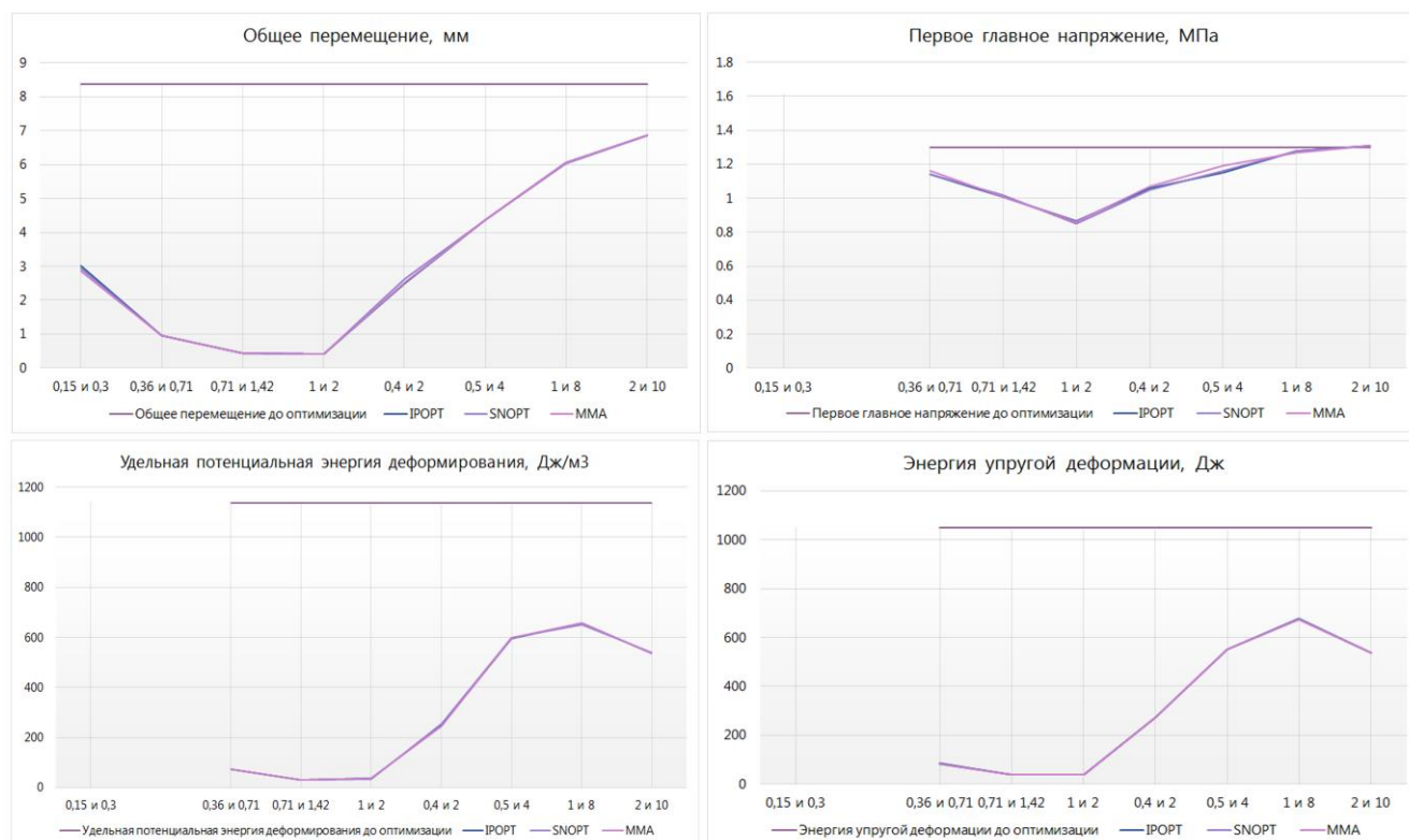
Рисунок 4.11 – Результаты оптимизации прямого геликоида с установкой варьируемых параметров d_{\max} и R_{\min}
