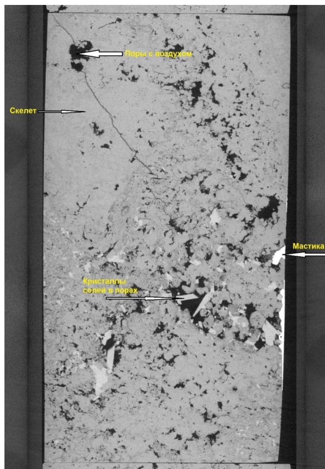
Рисунок 4.1 – Пример продольного среза образца после этапа пробоподготовки с малым количеством времени на удаление солей (сделано автором)
