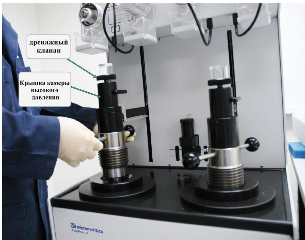
Рисунок 5.17 – Установка пенетromетра в блок высокого давления (сделано автором)
