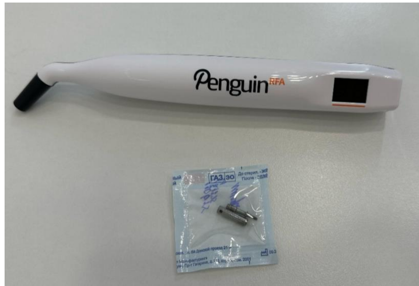
Рисунок 16 - Прибор Penguin RFA (Integration Diagnostics Sweden AB, Гётеборг, Швеция) для оценки имплантатной стабильности методом частотно-резонансного анализа.
