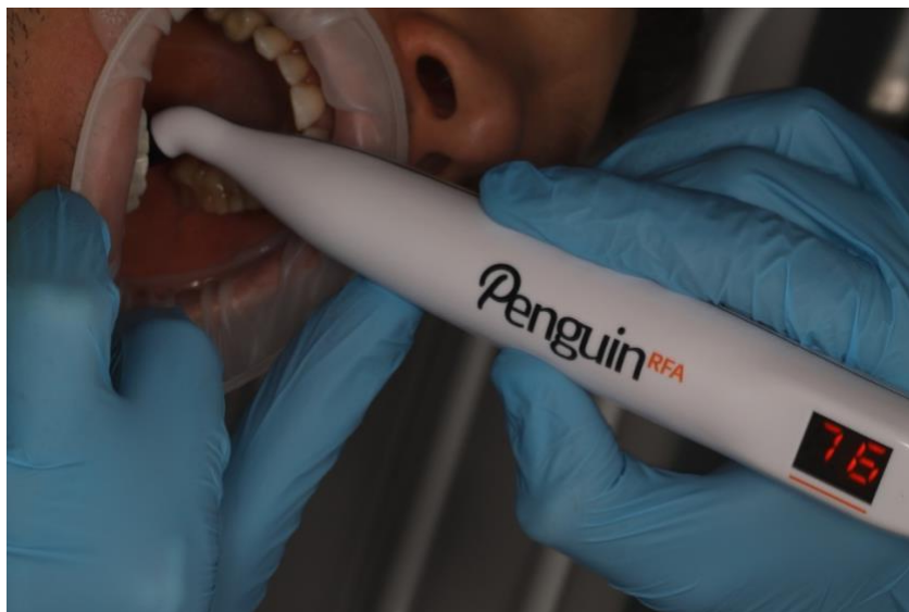
Рисунок 12 – Оценка стабильности дентальных имплантатов с использованием прибора Penguin RFA (Integration Diagnostics Sweden АВ, Гётеборг, Швеция).
