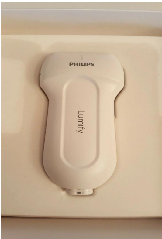
Рисунок 4. Аппарат УЗИ Philips lumify L12-4 с высокочастотным линейным датчиком
