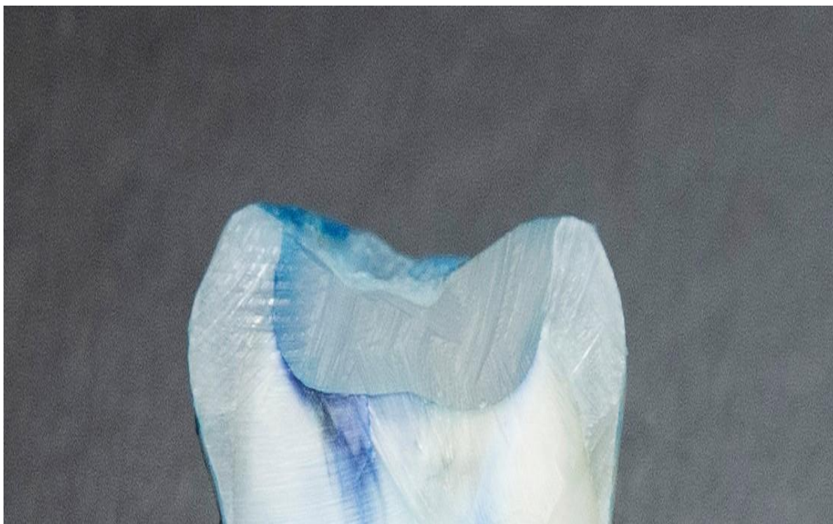
Рисунок 3.15 - Образец основной группы (после термоциклирования) протокола № 3 «с использованием увлажняющего агента», соответствующий оценке 3 балла (увеличение \times 20 )
