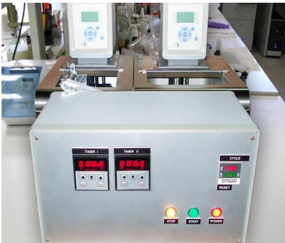
Рисунок 2.7 – Аппарат для термоциклирования образцов
