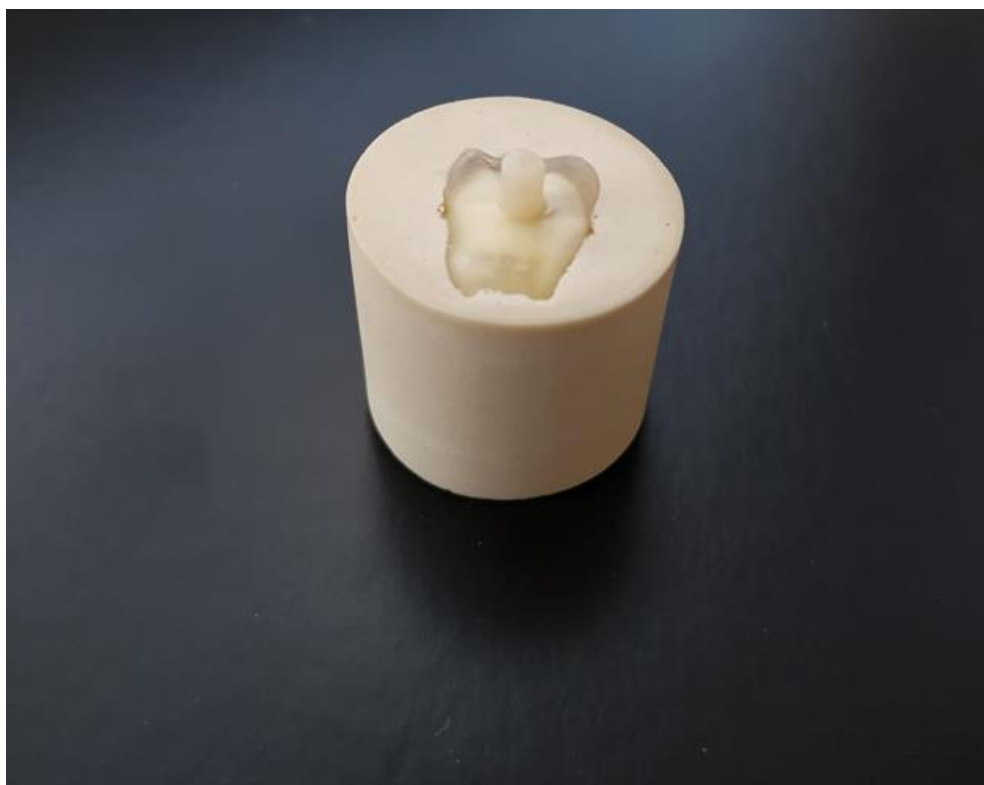
Рисунок 2.8 – Образец для испытания адгезионной прочности
