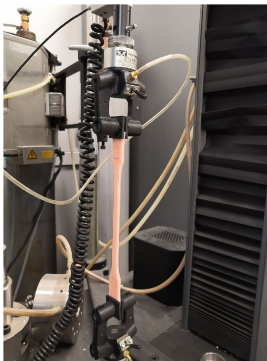
Рисунок 8 – Образец конструкционного материала, изготовленного методом объемной печати, в зажимах устройства во время испытания.
