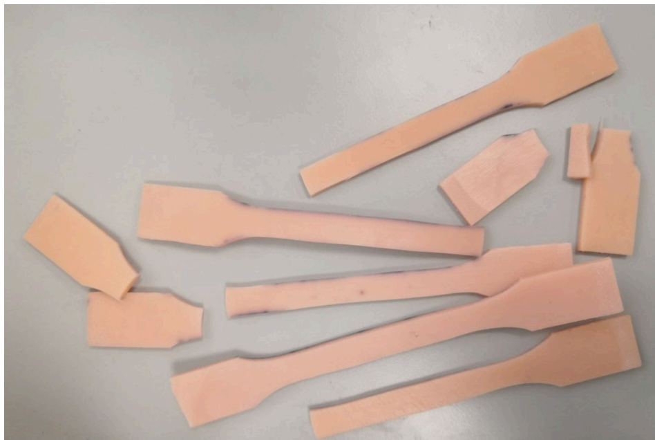
Рисунок 60 — Вид образцов происшедших форсированное старение имитирующие 6 месяцев использования после испытания на одноосное растяжение.
