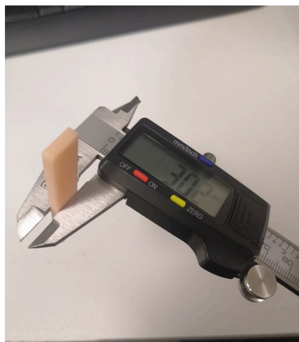
Рисунок 10 – Измерение образцов конструкционного материала, изготовленных методом объемной печати, перед испытанием на трехточечный: А- измерение толщины рабочей части образцов; Б - измерение ширины рабочей части образцов.
