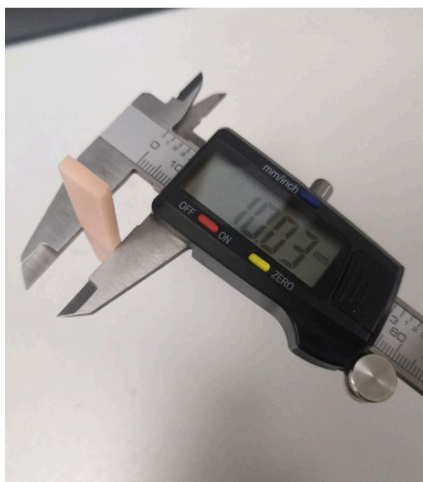
Рисунок 10 – Измерение образцов конструкционного материала, изготовленных методом объемной печати, перед испытанием на трехточечный: А- измерение толщины рабочей части образцов; Б - измерение ширины рабочей части образцов.
