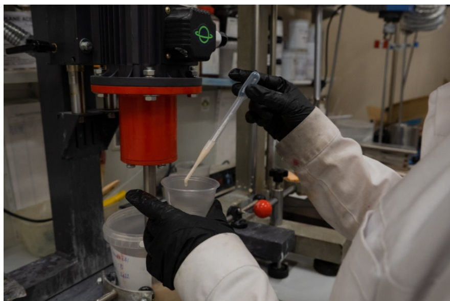
Рисунок 41 – Добавление фотоинициатора и пигментов в разработанный конструкционный материал при производстве.
