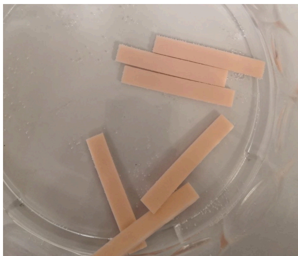
Рисунок 11 – Выдерживание образцов конструкционного материала, изготовленных методом объемной печати, в тёплой воде перед испытанием на трехточечный изгиб.
