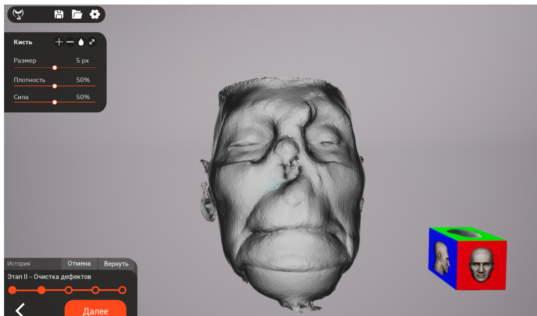
Рисунок 80 – Коррекция STL-файла в программе «Феникс 3D»: удаление поднутрений, сглаживание неровностей.
