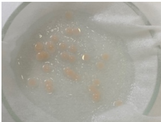
Рисунок 21 – Постобработка образцов исследуемого конструкционного материала в этиловом спирте.
