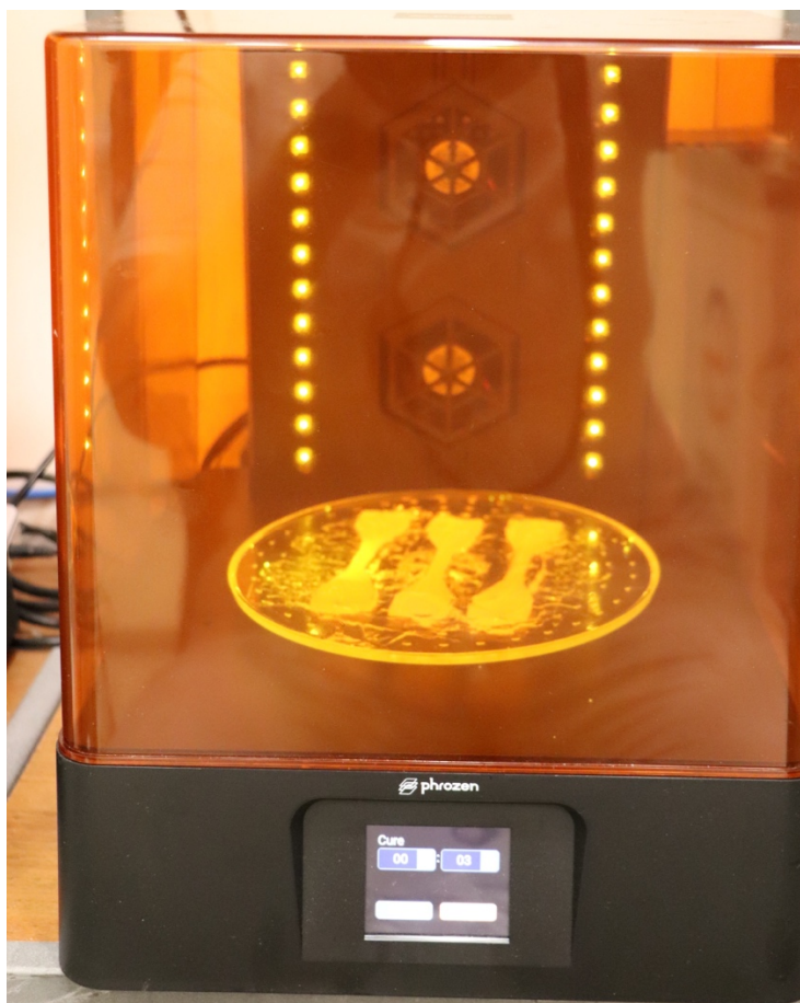
Рисунок 4 – Постпечатная полимеризация образцов для испытаний в специальной ванночке Phrozen Cure Kit (Phrozen, Тайвань).
