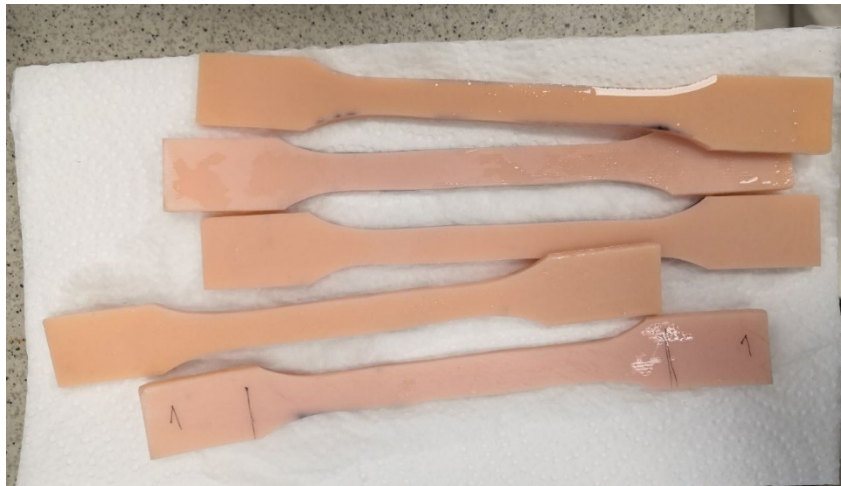
Рисунок 49 — Образцы исследуемого материала после прохождения испытания на форсированное старение 6 месяцев.
