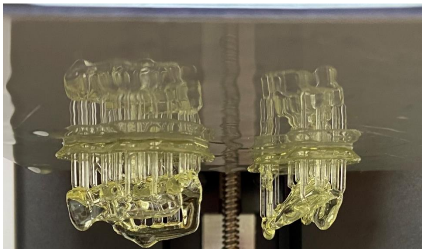
Рисунок 11 - Хирургические навигационные шаблоны, изготовленные методом 3D-печати из стоматологического полимера на 3D принтере
