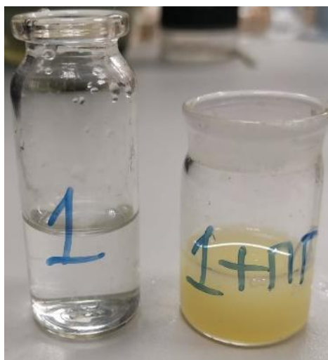
Рисунок 34 – 1 – исходный вид раствора 3%-го гипохлорита натрия. 1 + ПГ – результат смешивания 3%-го гипохлорита натрия с раствором на основе полигексанида («Лавасепт»)
