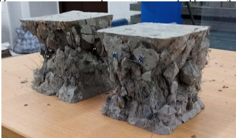
Рисунок 9 – Разрушенные образцы-кубы
