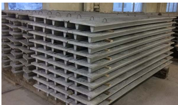
Рисунок 1.5 – Некоторые типы плит несъемной опалубки из фибробетона
