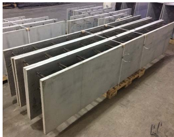
Рисунок 1.5 – Некоторые типы плит несъемной опалубки из фибробетона
