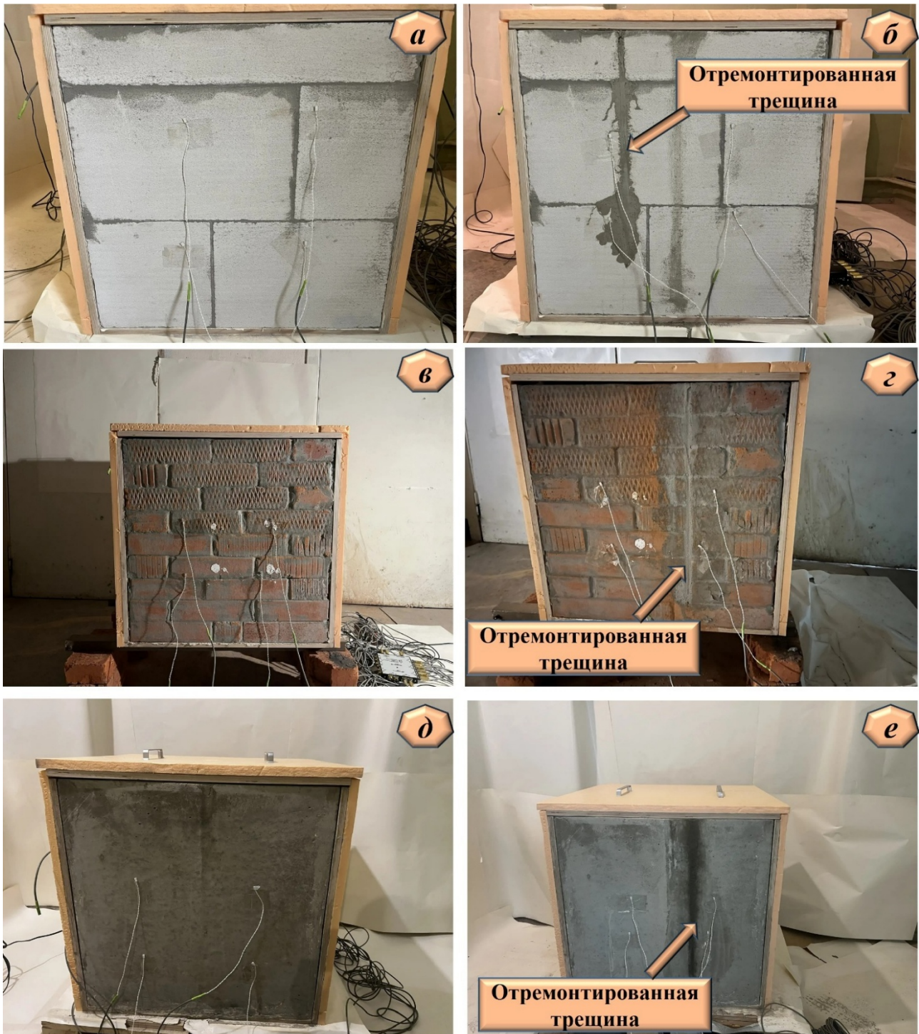
Рисунок 9. Фотографии предложенных экспериментальных устройств с установленными на них образцами стен зданий (а – пенобетон; б – пенобетон с отремонтированной трещиной; в – кирпич; г – кирпич с отремонтированной трещиной; д – железобетон; е – железобетон с отремонтированной трещиной).
