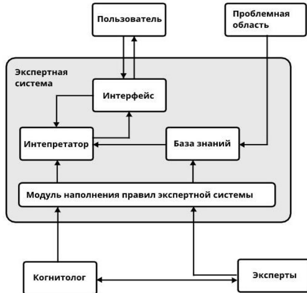
Рис. 9. Обобщённая структурно-функциональная схема разработанной экспертной системы
