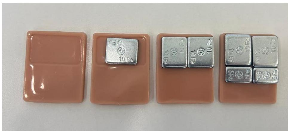
**Рисунок 8** – Образцы конструкционного материала с утяжелителями для оценки адгезивной способности разработанного клея справа-налево: 5 гр, 15 гр, 25 гр, 35 гр.
