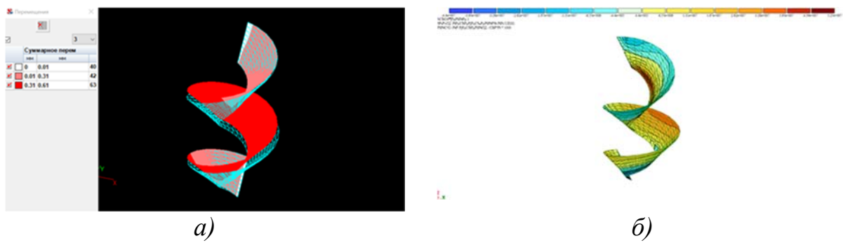
Рис. 4.9. Суммарное перемещение для развертывающегося геликоида: а – в SCAD; б – в Лира Сапр.
