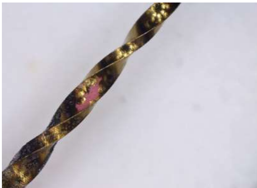
Рисунок 33 – Protaper gold F3, прокрашивание дефекта при проведении капиллярной дефектоскопии
