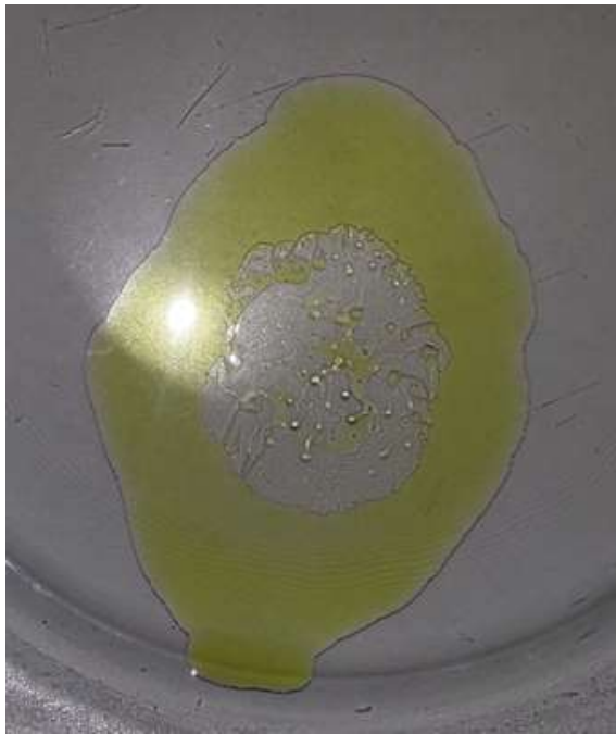
Рисунок 17 – Реакция грейпфрутового эфирного масла с 3,25% раствором гипохлорита натрия
