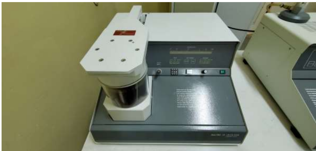
Рисунок 5 – Камера катодного напыления установки Val-Тес SCD005 (Бальцерс, Лихтенштейн)
