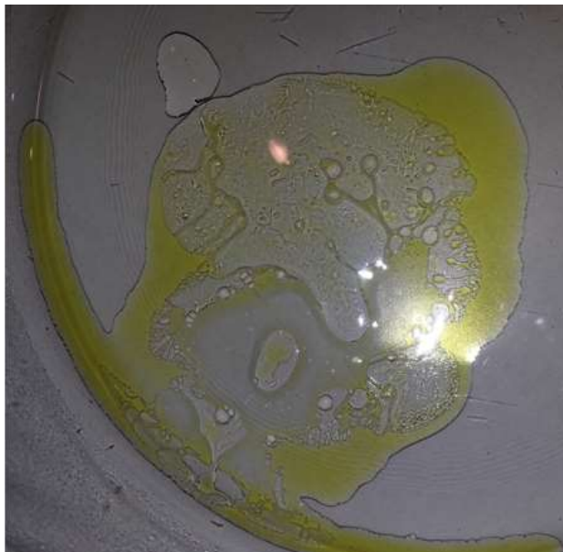
Рисунок 18 – Реакция грейпфрутового эфирного масла с 1% раствором гипохлорита натрия, нагретого до 45°C
