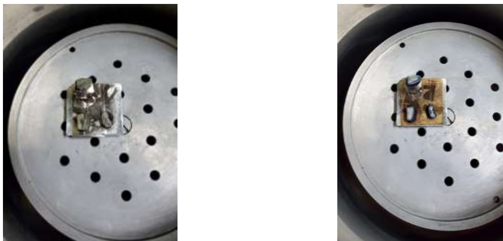
Рисунок 4 – Слева: наклеенные образцы на медную пластину с помощью двухстороннего электропроводного скотча без напыления. Справа: наклеенные образцы на медную пластину с помощью двухстороннего электропроводного скотча после напыления платиной в атмосфере аргона
