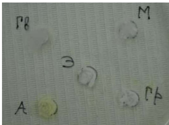
Рисунок 12 – Растворение силера АН plus в различных эфирных маслах
