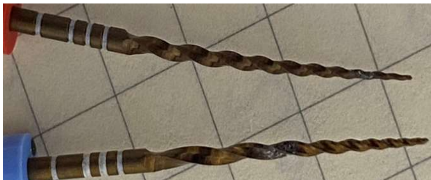
Рисунок 30 – Protaper X1 и SOCO SC PRO 25/06: отмечается отсутствие золотистого напыления в области предполагаемого отлома
