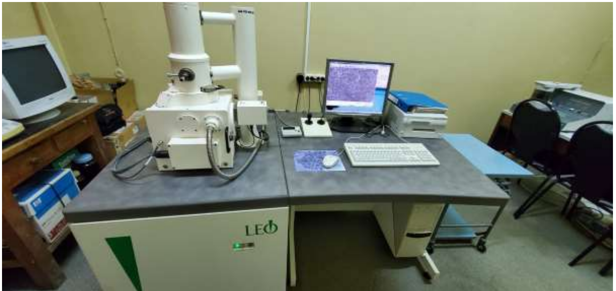
Рисунок 6 – Сканирующий электронный микроскоп LEO-1430 VP (Карл Цейс, Германия)
