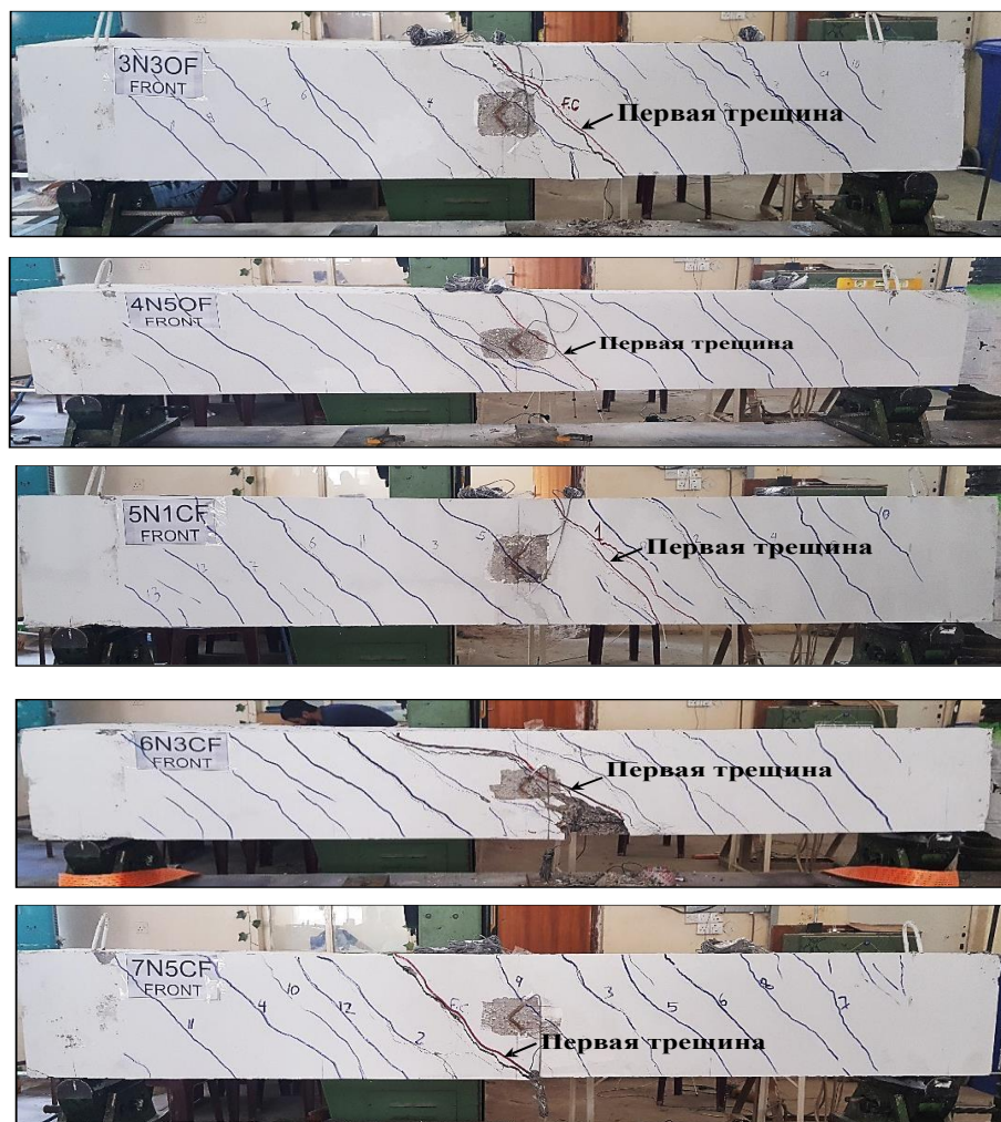
Рисунок 7 – Механизм разрушения образцов без предварительного напряжения (1 категория)
