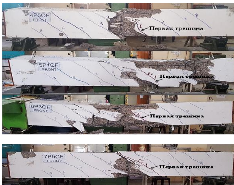
Рисунок 8 – Механизм разрушения предварительно напряженных образцов (2 категория)
