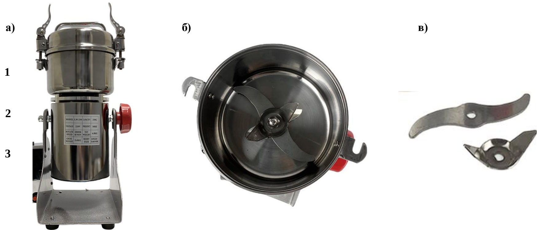
Рисунок 13. Высокоскоростная лабораторная мельница Stegler LM-250: а) общий вид: 1 – размольная емкость с замками; 2 – щёточный электродвигатель; 3 – панель управления; б) размольная чаша мельницы с системой ножей; в) цельнометаллические режущие ножи типа «trailing point»
