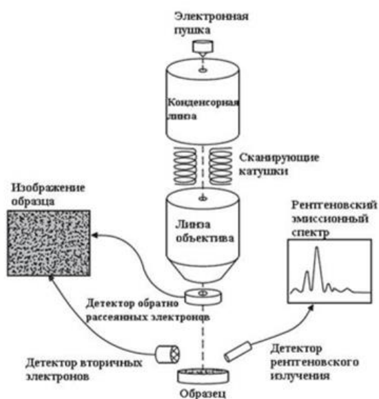
Рисунок 16. а) Общий вид сканирующего электронного микроскопа LYRA 3 (Tescan, Чехия) [92]; б) Схема сканирующего электронного микроскопа [93]
