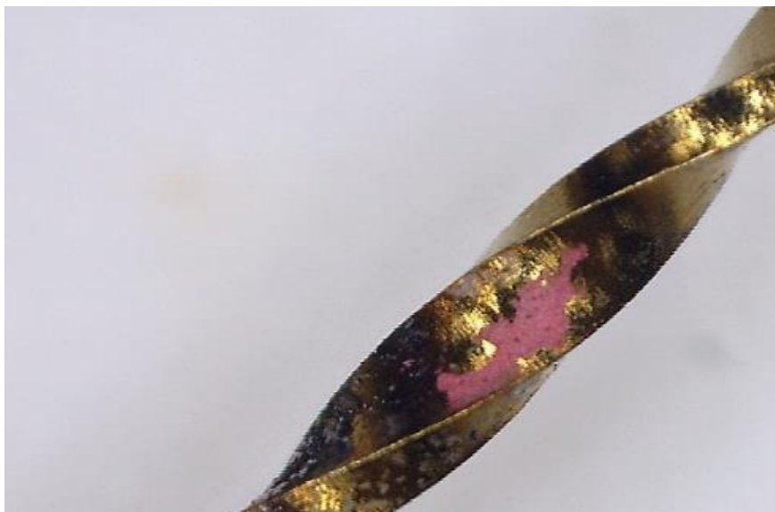
Рисунок 109 – Protaper gold F3, прокрашивание дефекта на поверхности инструмента при проведении капиллярной дефектоскопии
