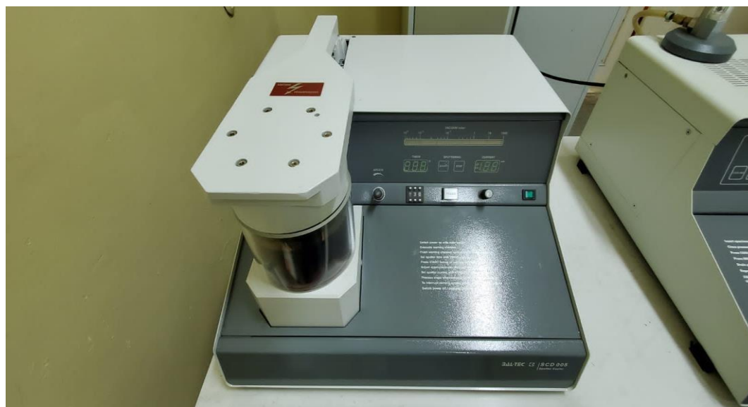
Рисунок 4 – Камера катодного напыления установки Bal-Tec SCD005 После
