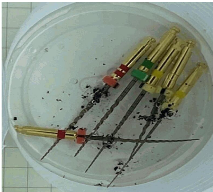
Рисунок 11 – Никель-титановый файл на этапе химического воздействия
