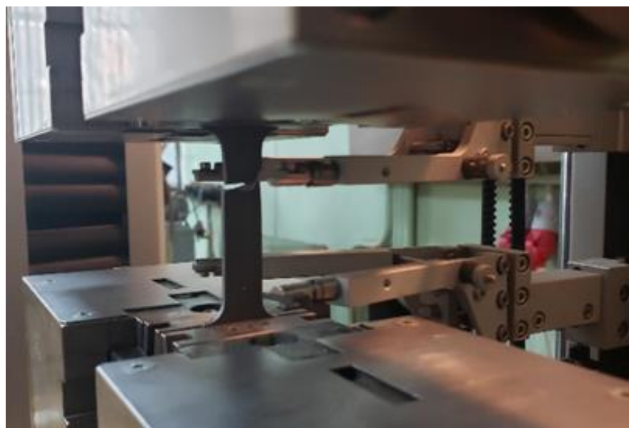
Рисунок 12. Закрепленный в установке Zwick Z100 (Германия) образец в момент разрушения.
