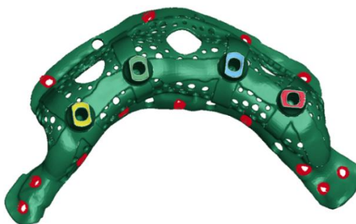
Рисунок 27. Вид сверху виртуальной модели сетки с выделенными зонами крепления к кости.
