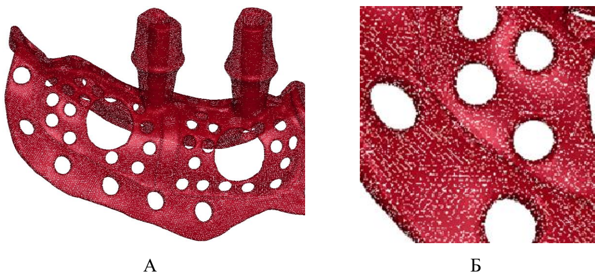
Рисунок 3 – Цифровая фасетная модель перфорированной титановой сетки: А – Целиком; Б – фрагмент.
