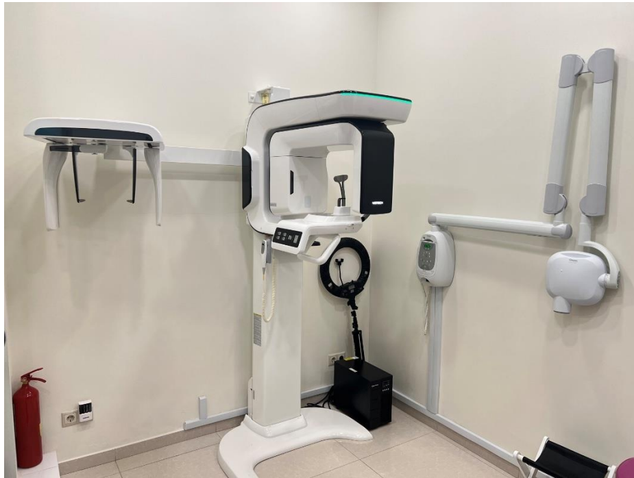
Рисунок 13 – Внешний вид конусно-лучевого компьютерного томографа Vatech PaX-i 3D (Vatech, Корея).
