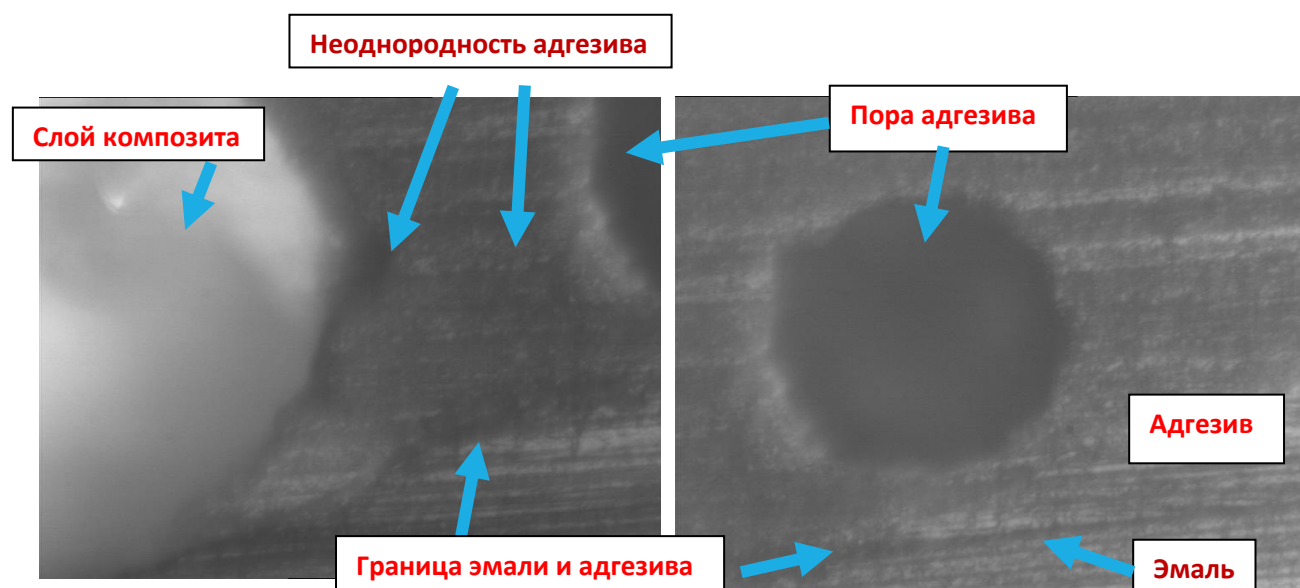
Рисунок 24 - Поры и неоднородность фиксирующего материала на границе с эмалью, ув.400х
