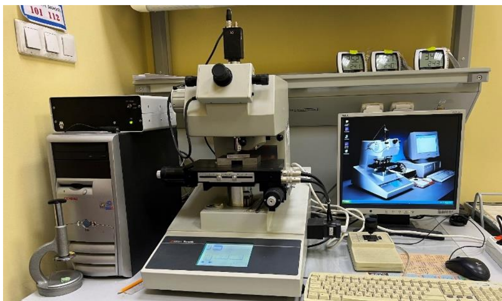
Рисунок 10 - Оптическая часть микротвердомера Duramin-20, фирмы Struers (Дания), увеличение 100x и 400x
