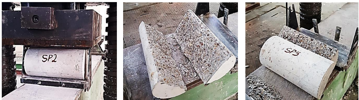
Рисунок 2-22. Схема разрушения образцов-цилиндров
