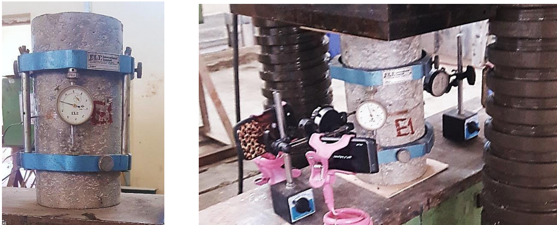
Рисунок 2-24. Испытания для определения модуля упругости
