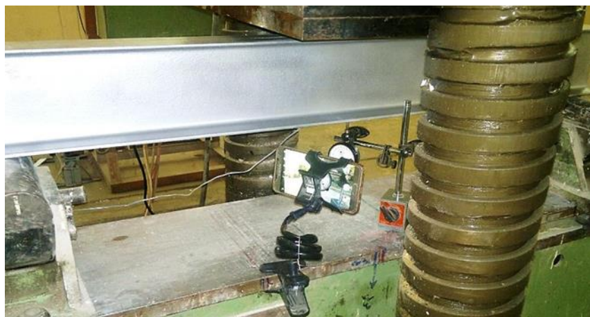
Рисунок 2-16 – Схема калибровочного испытания свободно опертой стальной балки
