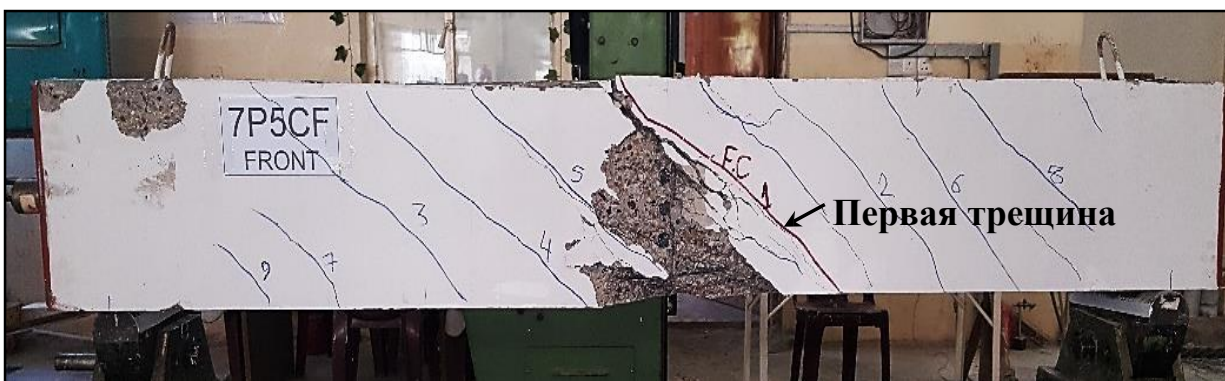
Рисунок 3-2 – Характер разрушения предварительно напряженных образцов (вторая категория). Продолжение
