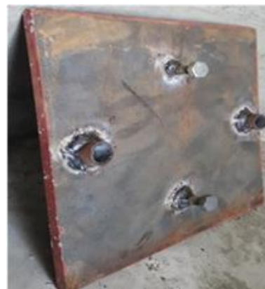
Рисунок 2-9 – Пенополистирольные блоки, торцевая пластина, пластиковый канал в предварительно напряженных образцах
