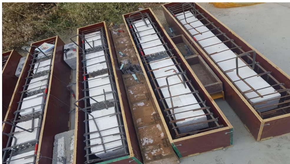
Рисунок 2-8 – Количество пенополистирольных блоков и их установка в образцах
