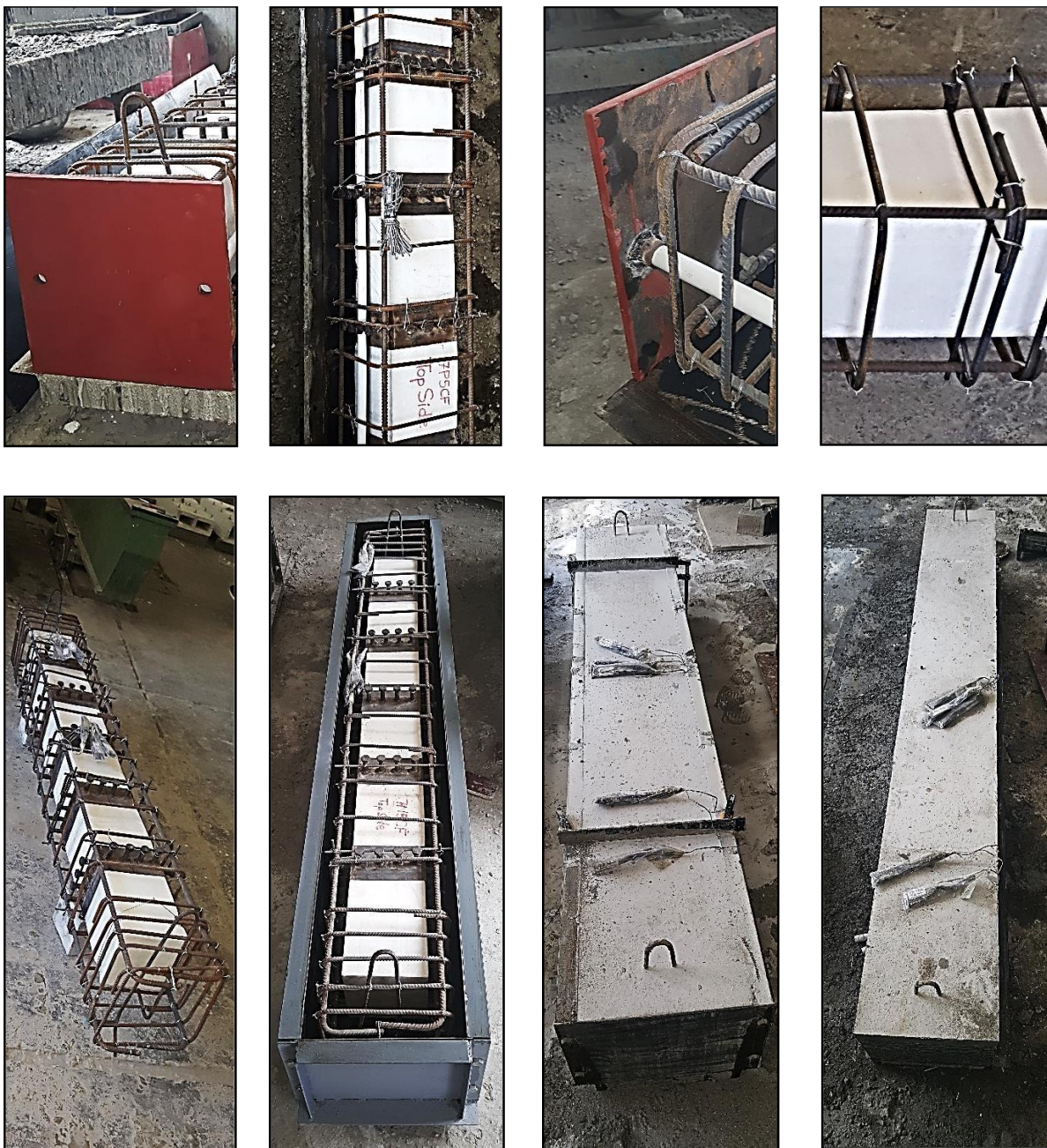
Рисунок 2-27 – Процесс изготовления экспериментальных образцов для испытания на кручение
