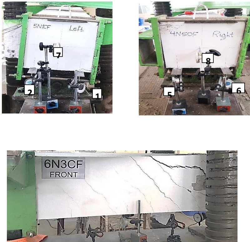
Рисунок 2-11 – Расположение индикаторов часового типа
