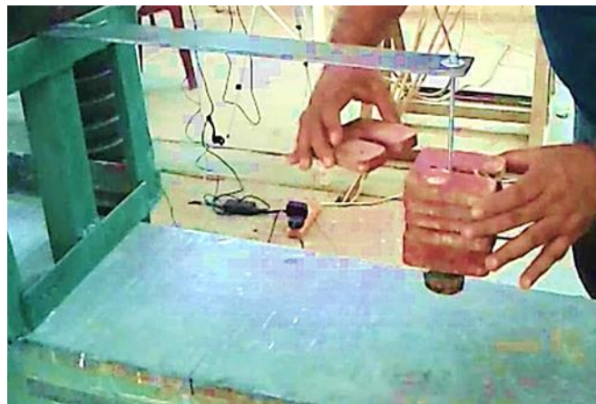
Рисунок 2-17 – Схема калибровочного испытания стальной консольной балки
