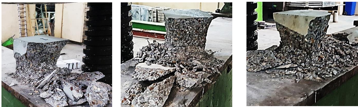
Рисунок 2-20. Схема разрушения образцов-кубов
