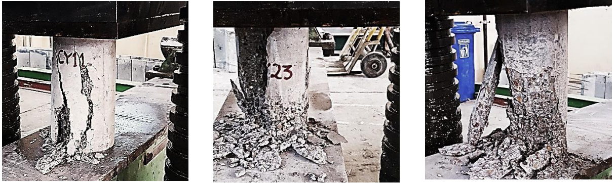
Рисунок 2-21. Схема разрушения образцов-цилиндров
