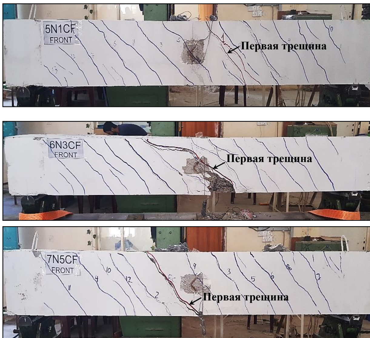
Рисунок 3-1 – Характер разрушения образцов без предварительного напряжения (первая категория). Продолжение
