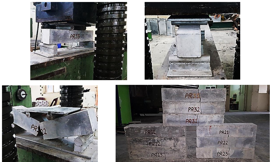
Рисунок 2-23. Испытания для определения прочности на растяжение при изгибе
