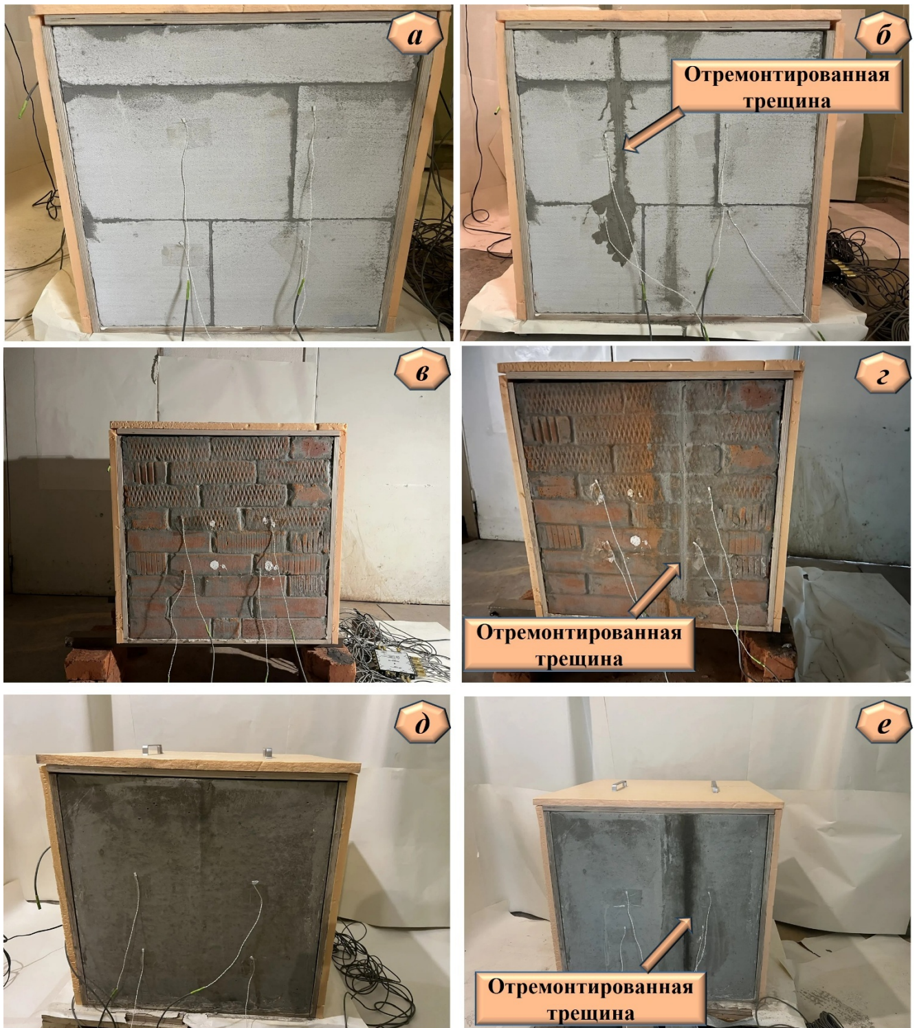
Рисунок 4.6. Фотографии предложенных экспериментальных устройств с установленными на них образцами стен зданий (а – пенобетон; б – пенобетон с отремонтированной трещиной; в – кирпич; г – кирпич с отремонтированной трещиной; д – железобетон; е – железобетон с отремонтированной трещиной).
