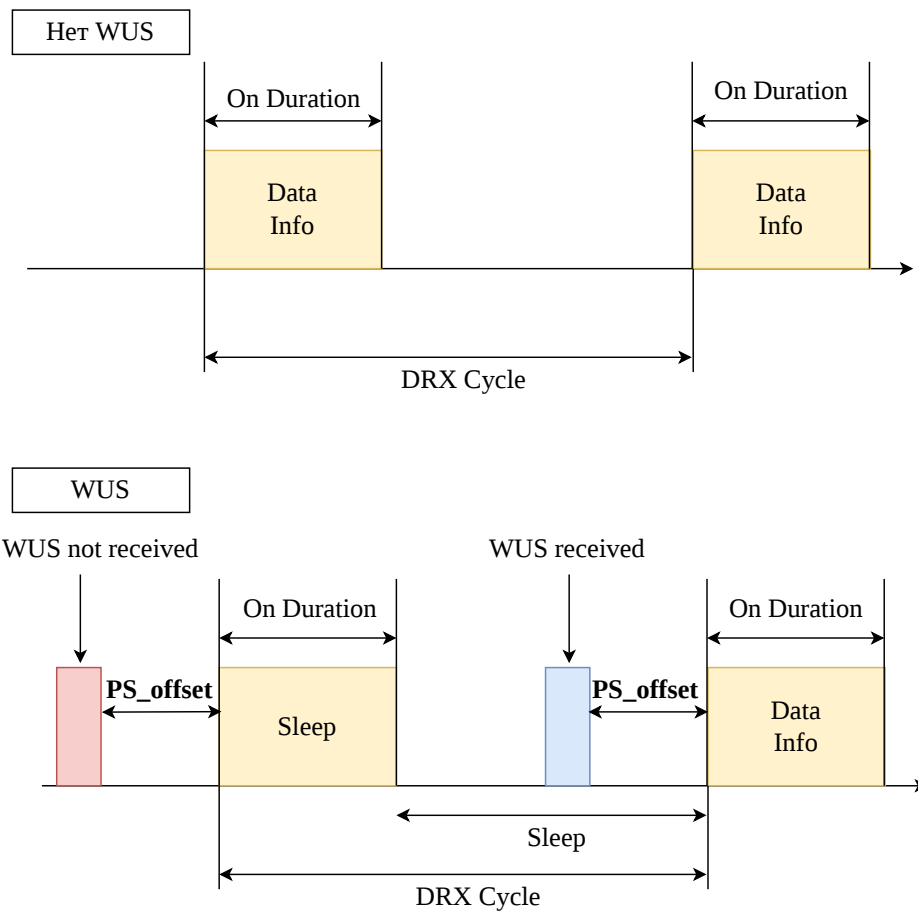
Рис. 1.5. Схема работы механизма сигнала пробуждения WUS
