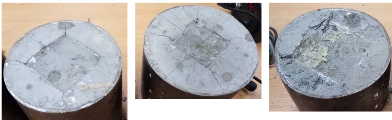
Рис. 7. Характер разрушения образцов
