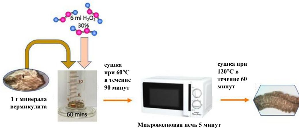
**Рисунок 14** Схема получения модифицированного вермикулита
