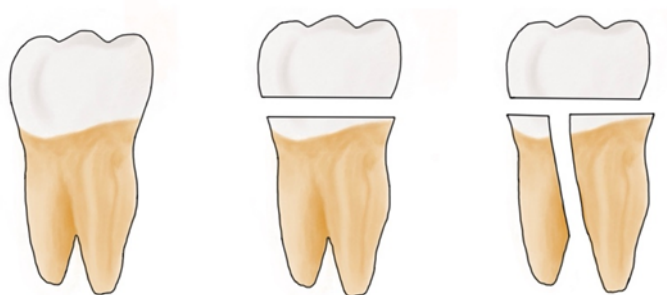
Рисунок 3 – Схема изготовления образцов корней зубов
