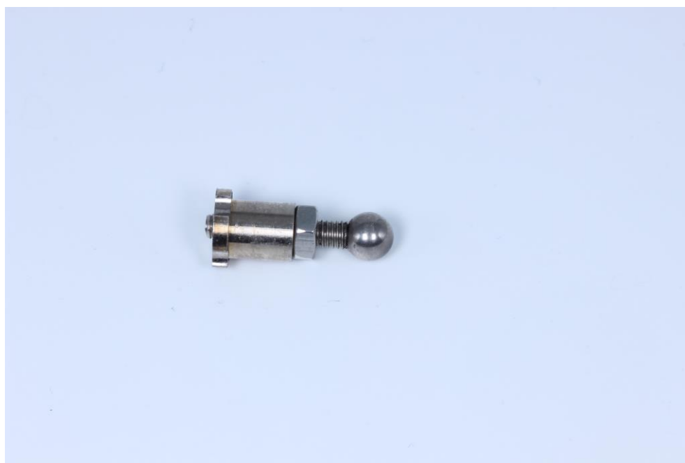
Рисунок 10 – Писчик в форме шара, контргайка и втулка с ретенционными пунктами в сборе
