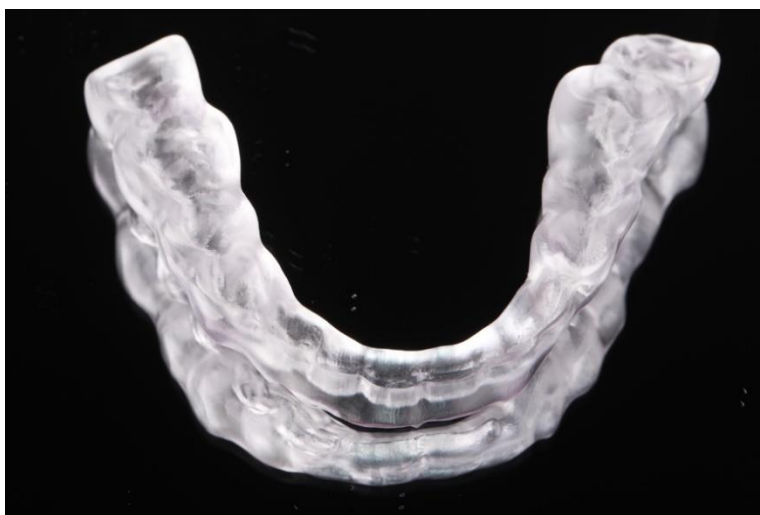
Рисунок 76 – Позиционирующая окклюзионная шина, изготовленная методом объемной печати из материала Harz Labs Dental Yellow Clear Pro
