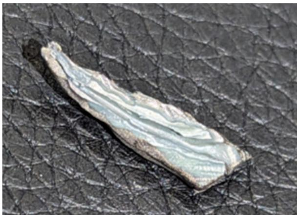
**Рисунок 7** – Продольный скол зуба, покрытый Au толщиной 20 нм. Образец 7.6
