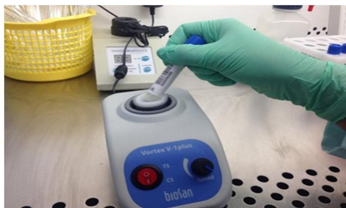
**Рисунок 2** – Приготовление суспензии с помощью Vortex
