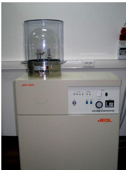
**Рисунок 11** – Установка для нанесения электропроводящего слоя методом термического напыления JEE-420
