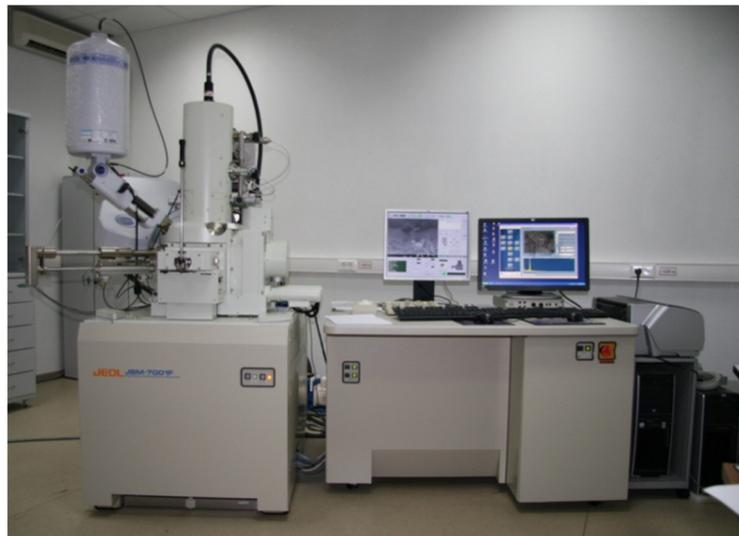
**Рисунок 5** – Сканирующий электронный микроскоп (СЭМ) JEOL JSM 7001-F (Япония)
