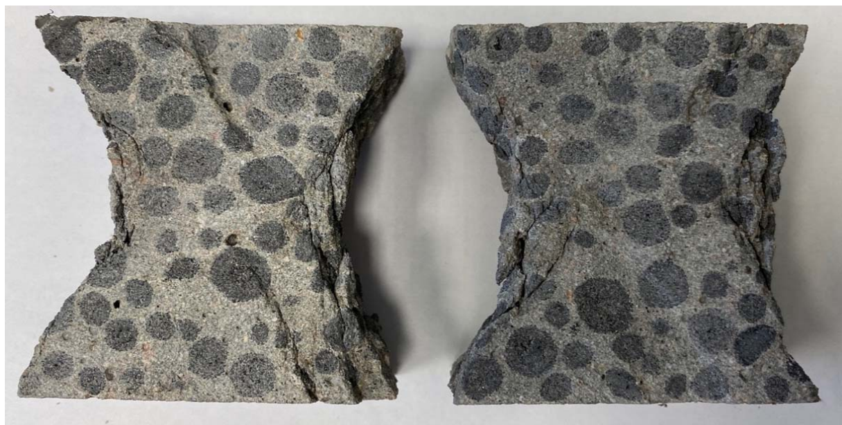
Рисунок 3.14 - Разрез кубикового образца бетона после испытания на сжатие
