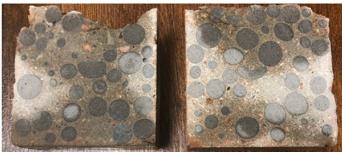
Рисунок 3.7 - Разрез кубикового образца бетона после испытания на сжатие
