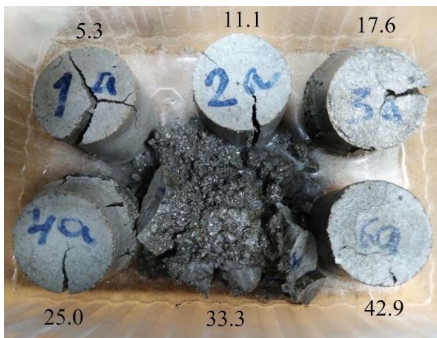
Рисунок 2.9 - Образцы из зольного теста с содержанием MS от 5,3 до 42,9 % от массы золы через 11 суток воздушного твердения и 2 суток пребывания в воде
