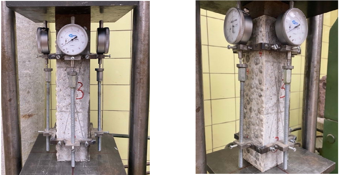
Рисунок 3.4 - Испытание на модуль упругости
