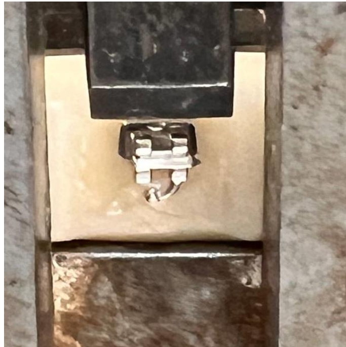
Рисунок 2.12 – Зафиксированный образец «Эсткер» перед испытанием на сдвиг Источник: составлено автором
