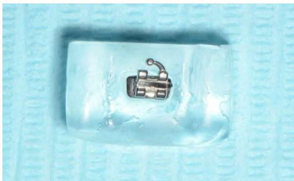
Рисунок 2.9 – Образец «Нолатек» с брекетом
