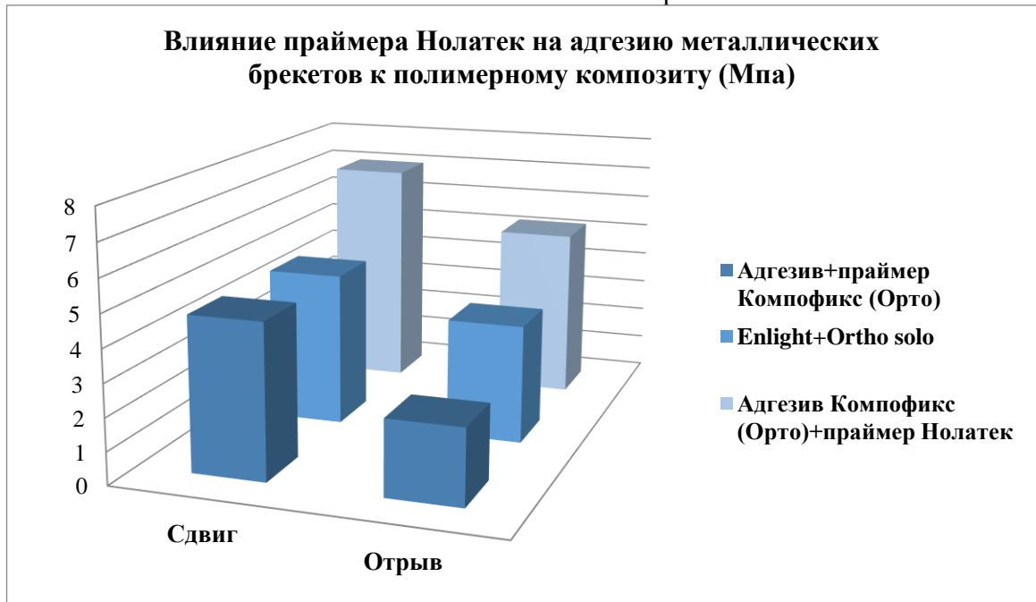
Рисунок 3.10 – Влияние праймера Нолатек на адгезию металлических брекетов к полимерному адгезиву
