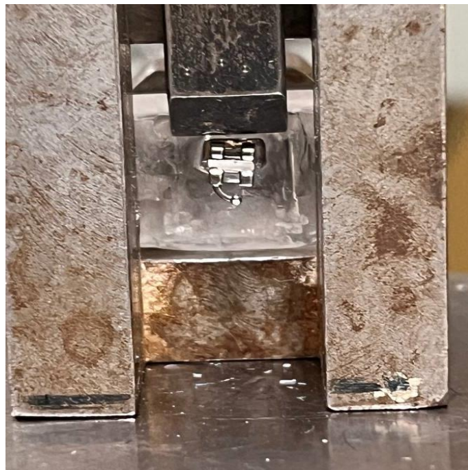
Рисунок 2.13 – Зафиксированный образец «Нолатек» перед испытанием на сдвиг Источник: составлено автором
