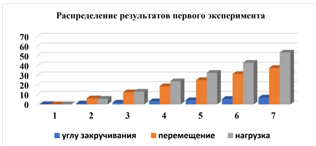
Рисунок 4.18–Распределение результатов первого эксперимента по приложенной нагрузке, углу закручивания и смещению точки приложения нагрузки.
