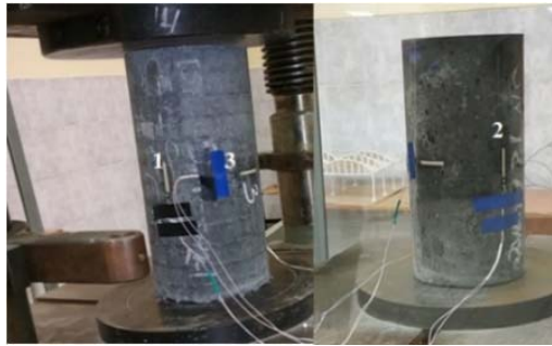
Рисунок 1. Расположение тензометрических датчиков на цилиндрической керамзитобетонной колонне
