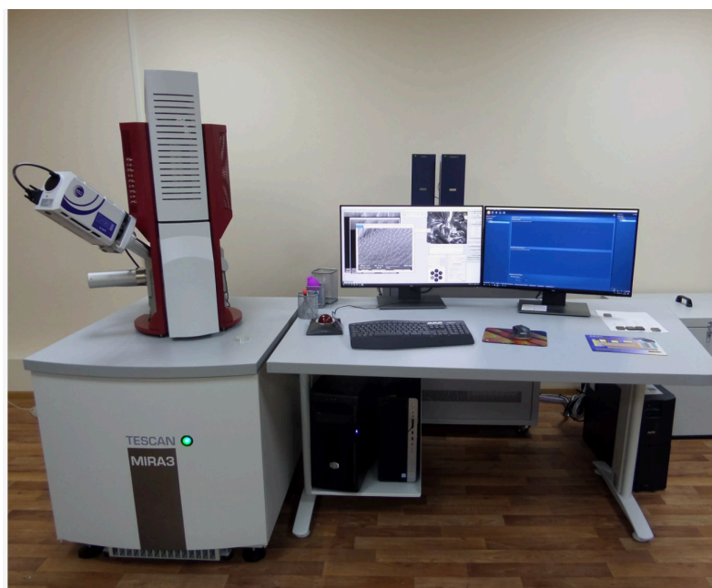
Рисунок 1 – Сканирующий электронный микроскоп «Mira 3 LMN» с энергодисперсионным рентгеновским спектрометром «AZtecEnergy Standard/X-max 20Tescan»
