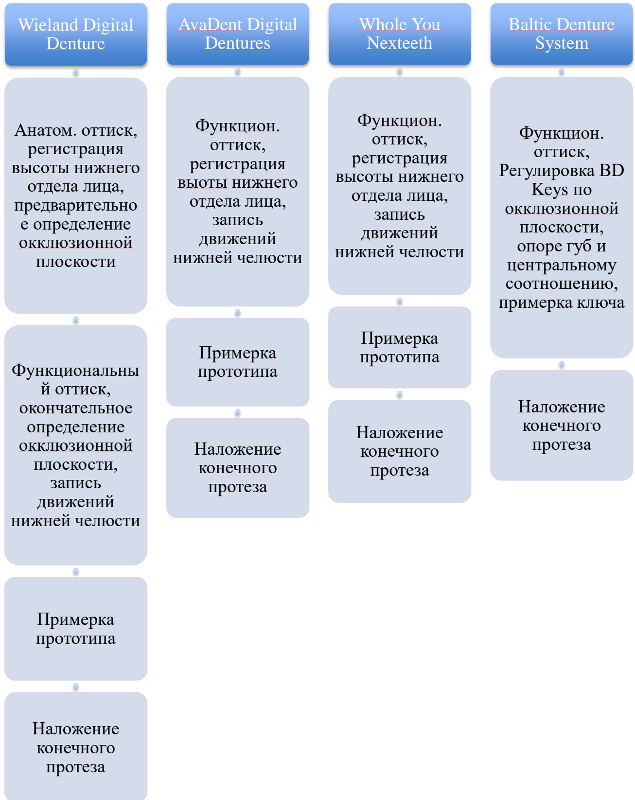
Рисунок 1. Блок-схема этапности протоколов изготовления CAD/CAM полных съёмных зубных протезов, в зависимости от посещений пациентом клиники.
