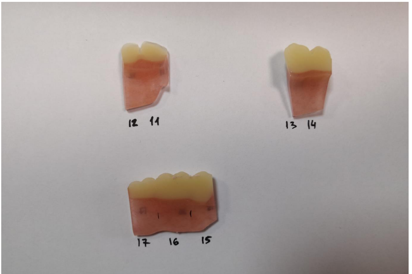
Рисунок 9. Исследуемые сегменты (фрагменты образцов, в которых соединение базиса с зубными рядами осуществлено пластмассой холодной полимеризации)
