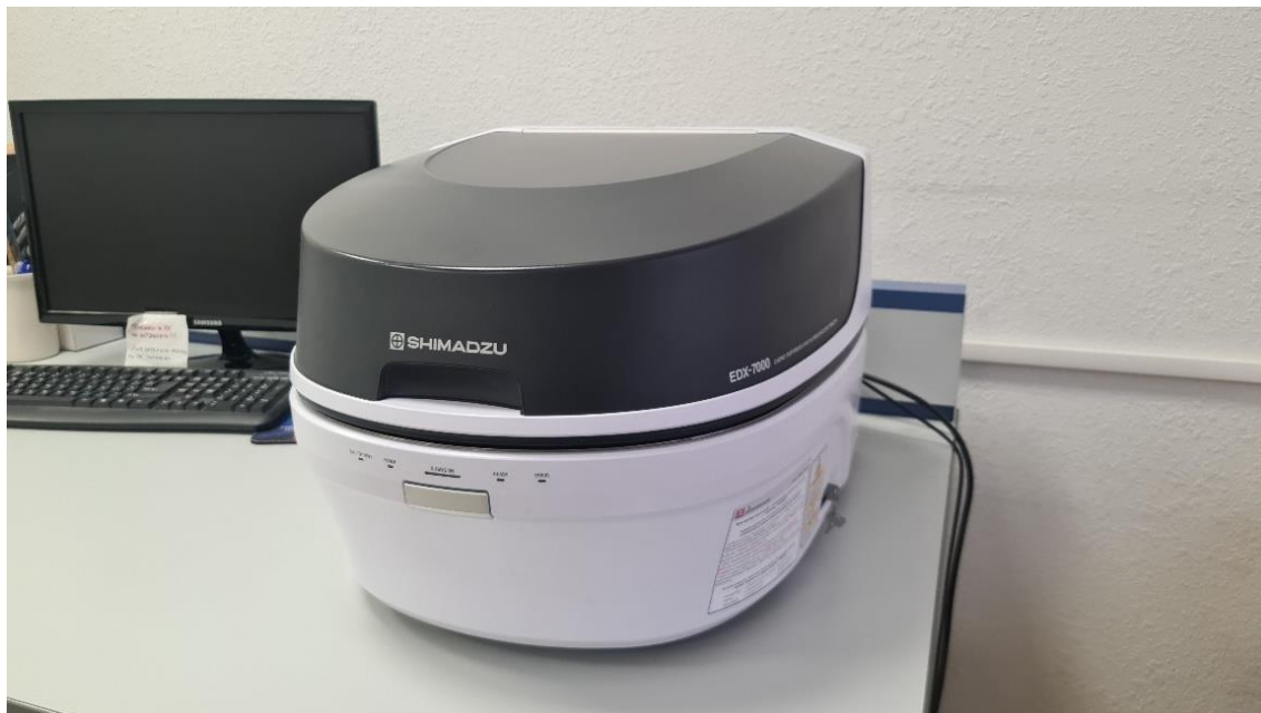
Рисунок 3. Оборудование - энергодисперсионный рентгенофлуоресцентный спектрометр EDX-7000 (Shimadzu, Япония)
