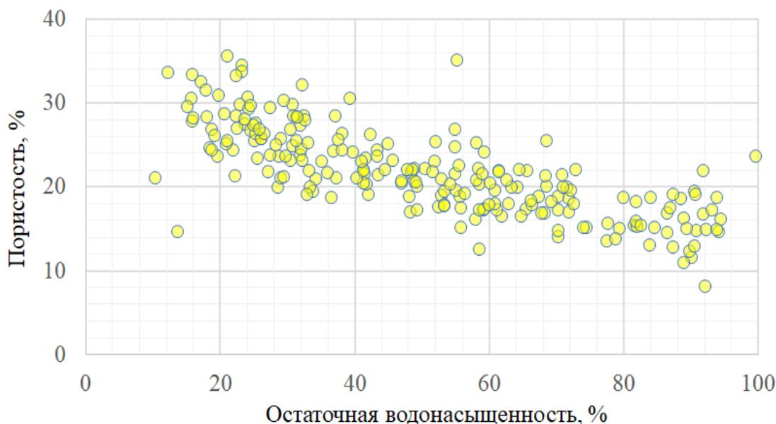
Рис. 3.3.1. Пример соотношения остаточной водонасыщенности и пористости терригенных отложений залежи верхнеюрского отдела <sup>54</sup>
