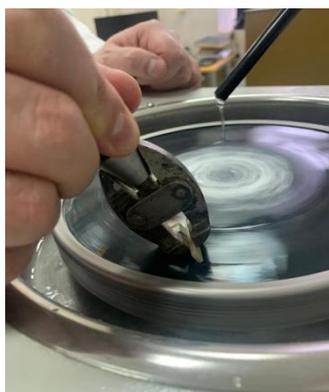
**Рисунок 4** - Изготовление фаски на отполированных образцах
