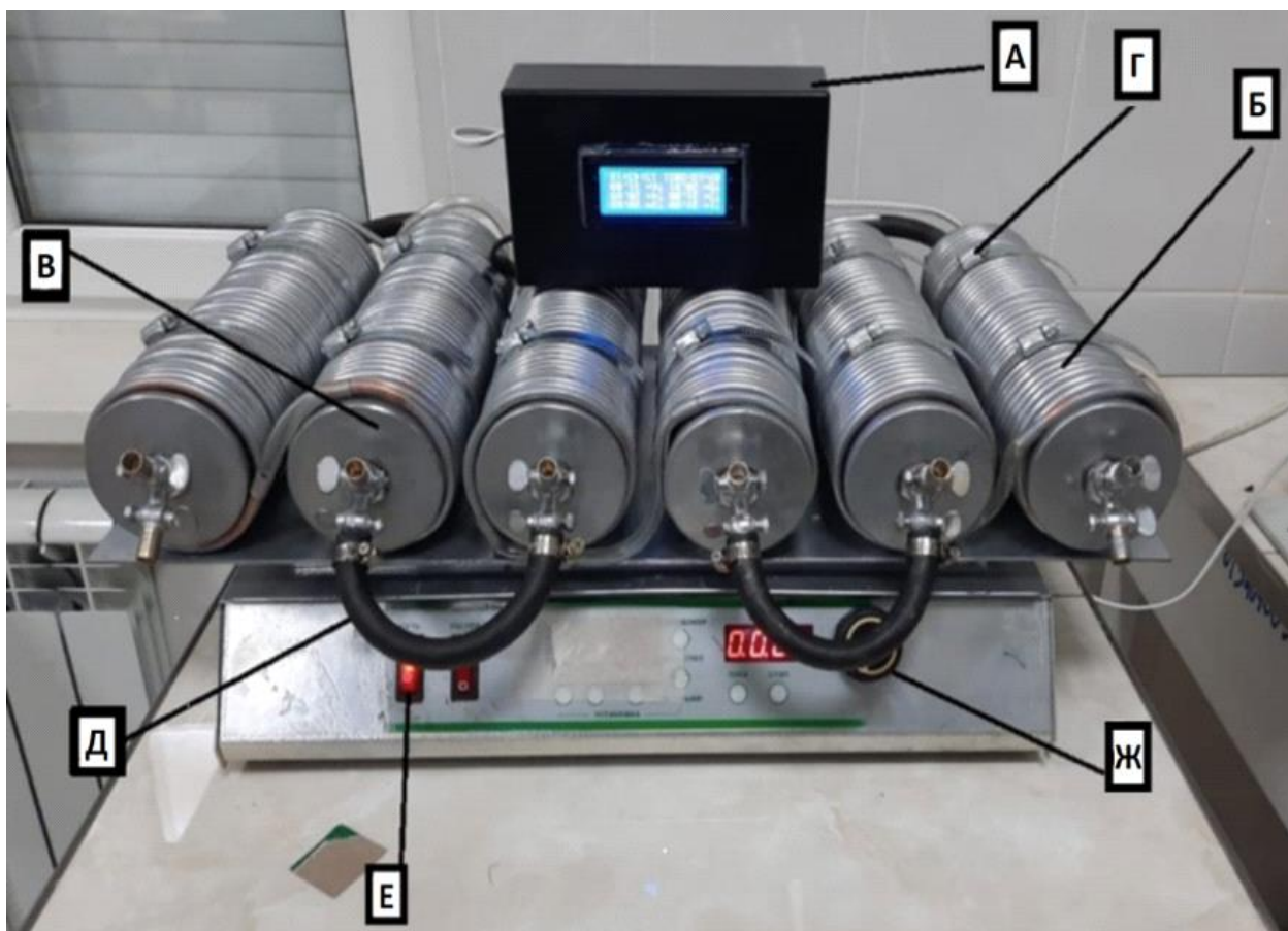
Рисунок. 1. Проточный химический реактор непрерывного смешивания жидкостей.
