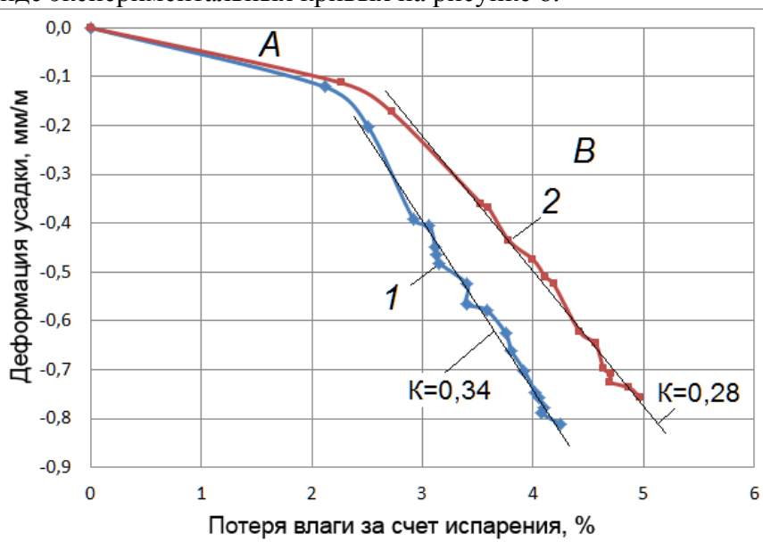
Рисунок 8 - Зависимость деформации усадки от потери воды на испарение: 1 – на сухих гранулах (состав №1); 2 – на водонасыщенных гранулах (состав №2)
