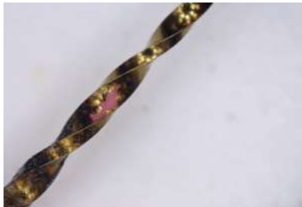
Рисунок 1 – Protaper gold F3, прокрашивание дефекта при проведении капиллярной дефектоскопии
