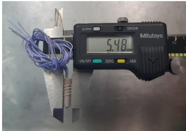
**Рисунок 25** – измерение размера узлового якорного фиксатора
