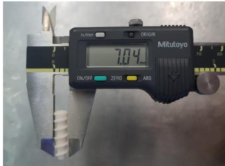
**Рисунок 26** – измерение размера интерферентного винтового фиксатора
