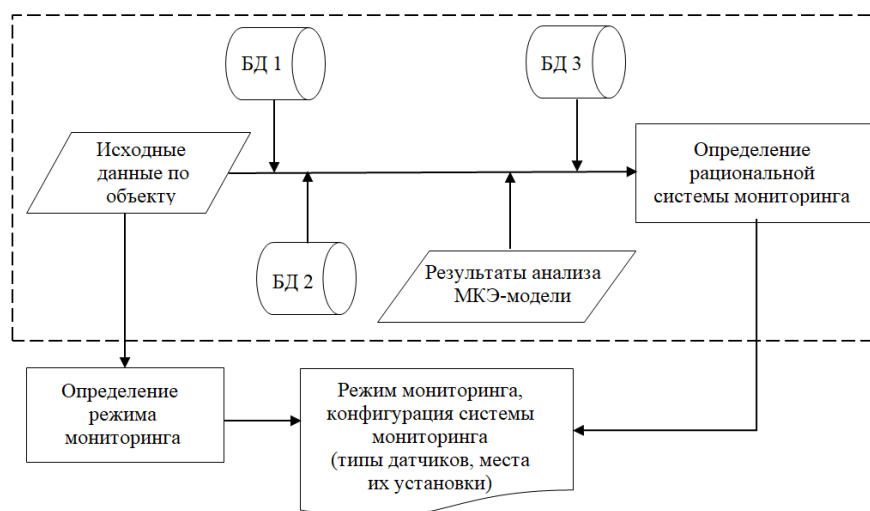
Рисунок 4. Схема функционирования информационной технологии проектирования систем мониторинга для объектов строительства
