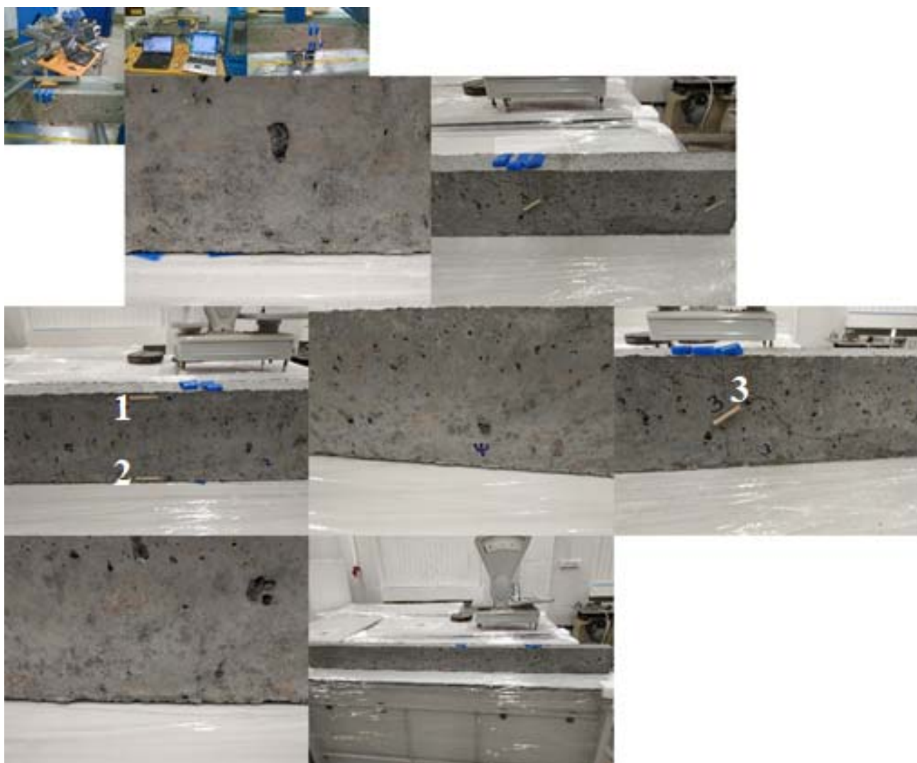
Рисунок 3.25 - Испытание на прогиб керамзитобетонной балки с дисперсной базальтовой фиброй, базальтовой и стальной арматурой (Балка типа 3)
