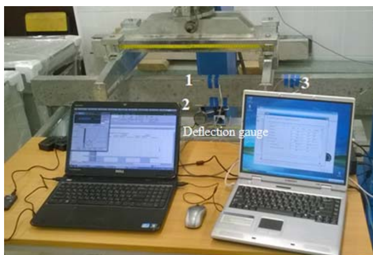
Рисунок 3.24 - Расположением датчиков на керамзитобетонной балке
