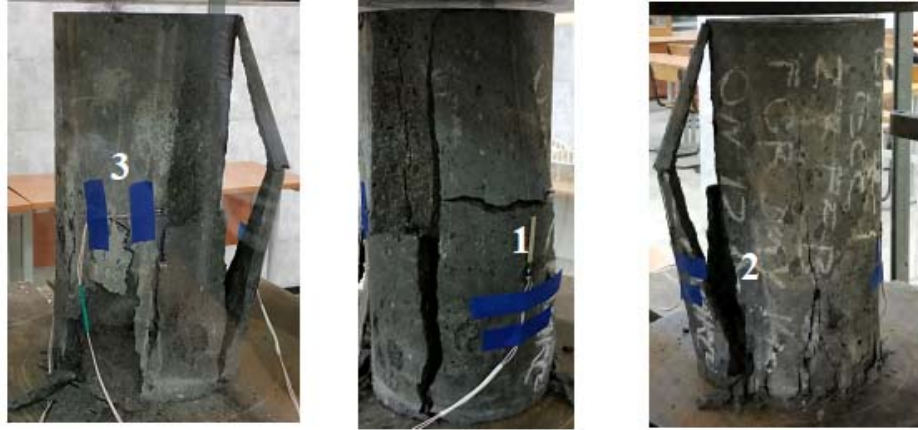
Рисунок 3.8 - Деформация керамзитобетонного цилиндрического колонна на датчики после приложения нагрузки (тип цилиндра 1)
