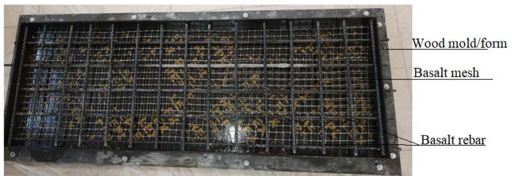
Рисунок 2.28 - Положение плиты в пресс-форме для армирования
