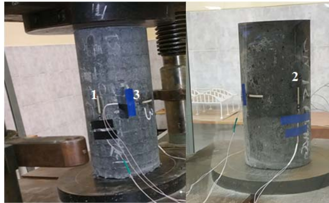
Рисунок 2.18 - Расположение тензометрических датчиков на цилиндрической керамзитобетонной колонне
