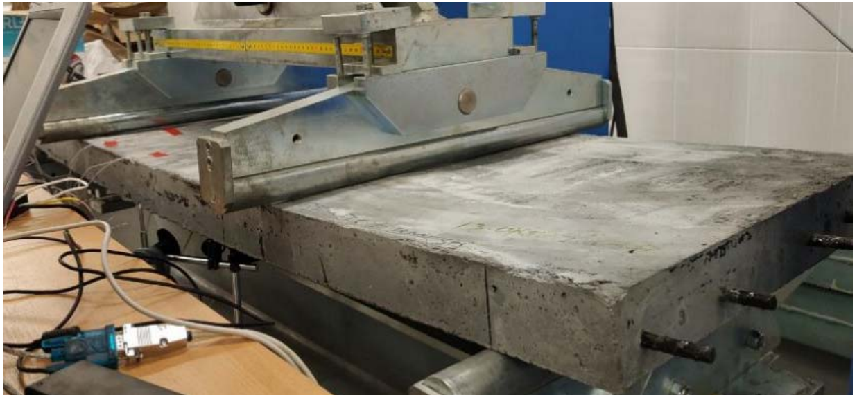
Рисунок 3.32 - Прогиб под нагрузкой керамзитобетонной плиты с базальтовой арматурой и сеткой (плита типа 3)
