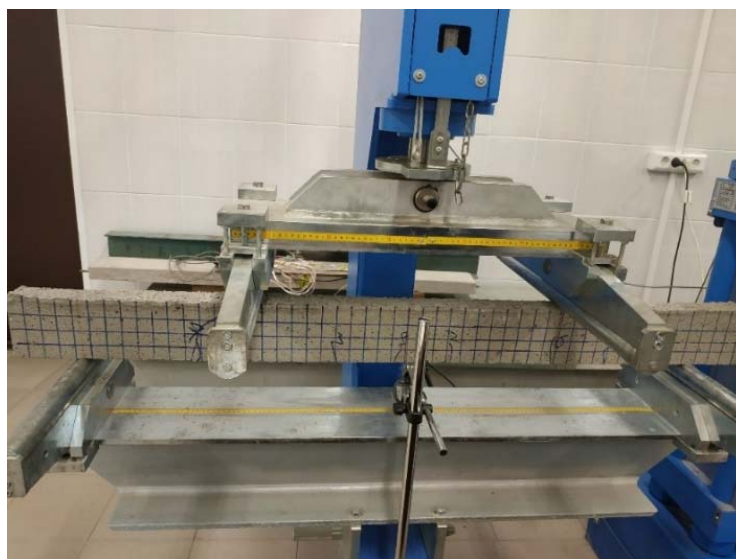
Рисунок 3.23 - Испытание на прогиб керамзитобетонной балки с дисперсной базальтовой фиброй и базальтовой арматурой (Балка типа 2)
