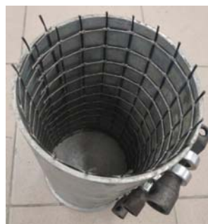
Рисунок 2.17 - Базальтофибровая полимерная сетка для внешнего усиления колонны из керамзитобетона с БФ
