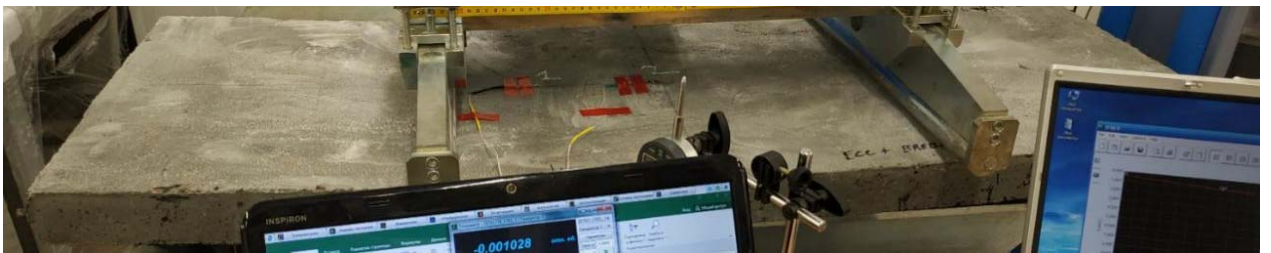
Рисунок 3.29 - Прогиб под нагрузкой керамзитобетонной плиты с базальтовой фиброй и базальтовой арматурой (плита типа 1)
