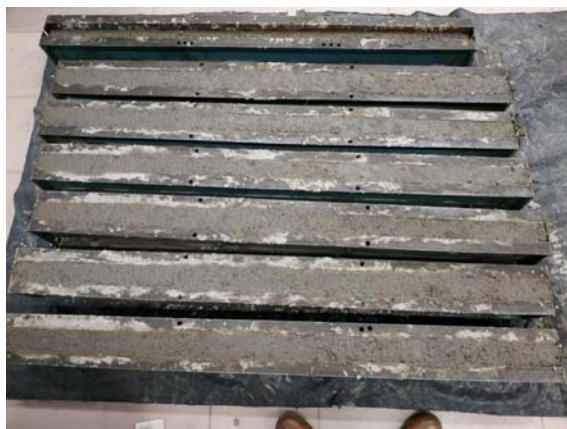
Рисунок 2.22 - Подготовка балки из облегченного керамзитобетона
