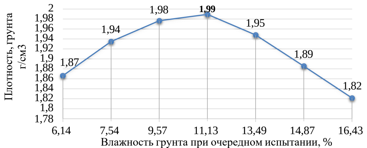
Рисунок 4.2 – Суглинок (Г-6). График зависимости значений плотности сухого грунта от влажности (график автора)
