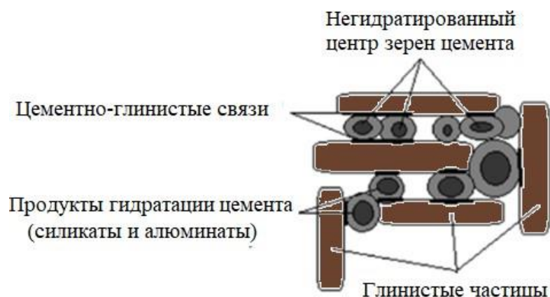
Рисунок 2.12 – Гидратация цемента в глинистых грунтах (рисунок автора [234])
