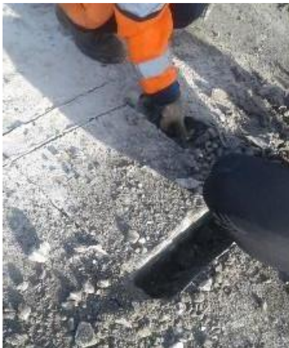
Рисунок 5.18 – Отбор проб укрепленного грунта Автомобильная дорога «Егоровщина – Рязановщина» (фото автора)
