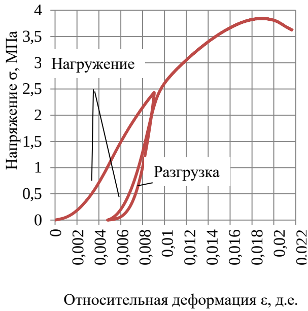
Рисунок 4.55 – Определение модуля упругости песка средней крупности, укрепленного портландцементом 6 % (рисунок автора)
