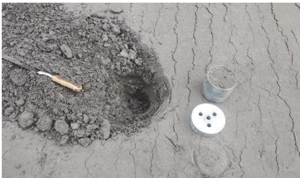
Рисунок 5.27 – Контроль качества уплотнения слоев земляного полотна методом режущего кольца (фото автора)
