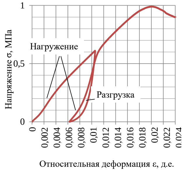
Рисунок 4.56 – Определение модуля упругости золошлаковой смеси, укрепленной портландцементом 6 % (рисунок автора)
