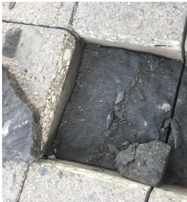
Рисунок 5.18 – Отбор проб укрепленного грунта Автомобильная дорога «Егоровщина – Рязановщина» (фото автора)
