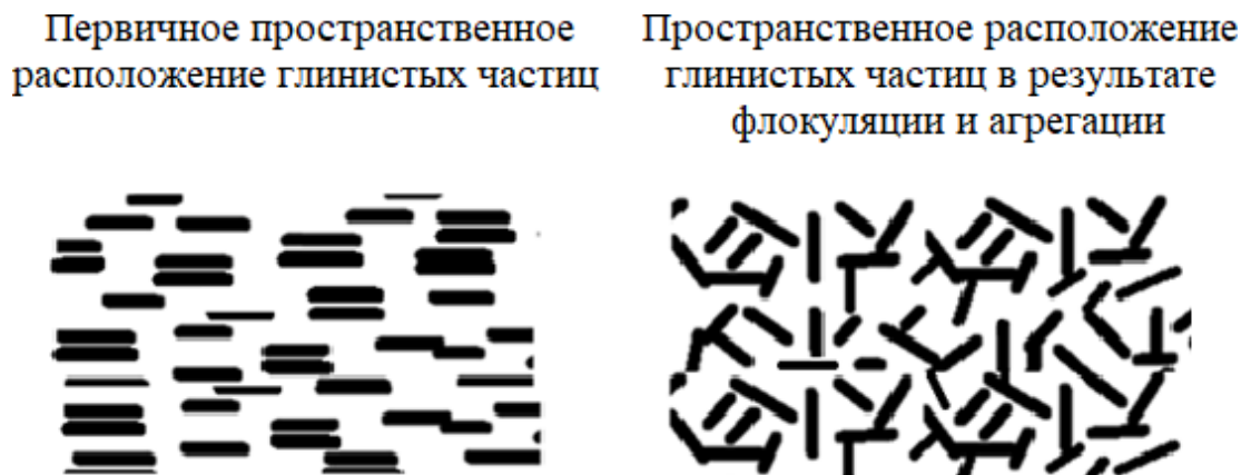
Рисунок 2.11 – Реструктуризация частиц (рисунок автора [234])
