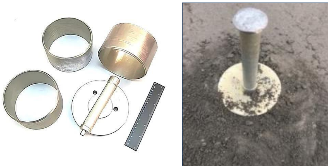
Рисунок 5.17 – Контроль плотности устроенного слоя из золошлаковой смеси, укрепленной портландцементом Автомобильная дорога «Егоровщина – Рязановщина» (фото автора)
