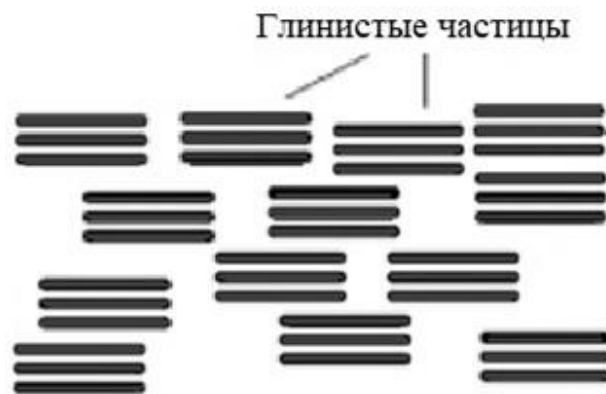
Рисунок 2.15 – Исходная структура глинистого грунта (рисунок автора [234])
