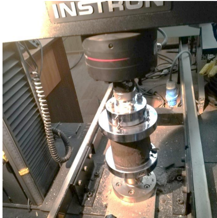
Рисунок 4.52 – Определение модуля упругости в лабораторных условиях (фото автора [220])
