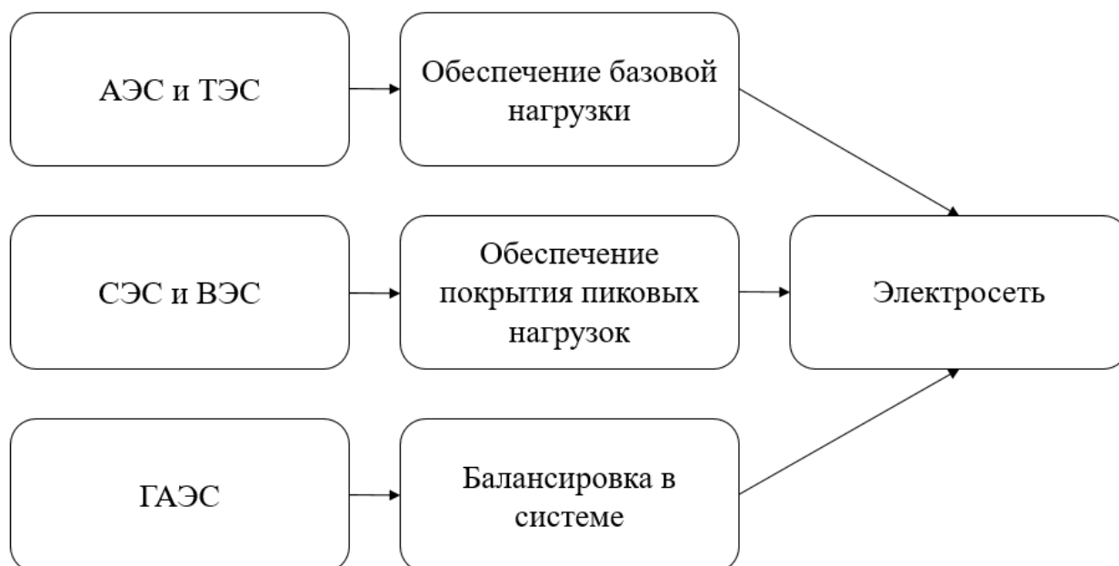
Рисунок 3.11. Принцип синхронизации ВИЭ с ЕЭС
