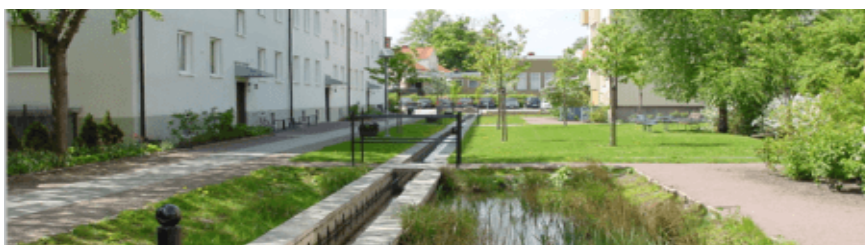
Рисунок 20 – Аугустенборге, Мальмё, дождевая система сбора воды
