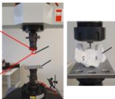
Рис. 2. Рабочая часть испытательной машины LFM-50. Установлен позвонок – имитатор из PLA – пластика для испытания условий прокалывания тела позвонка
